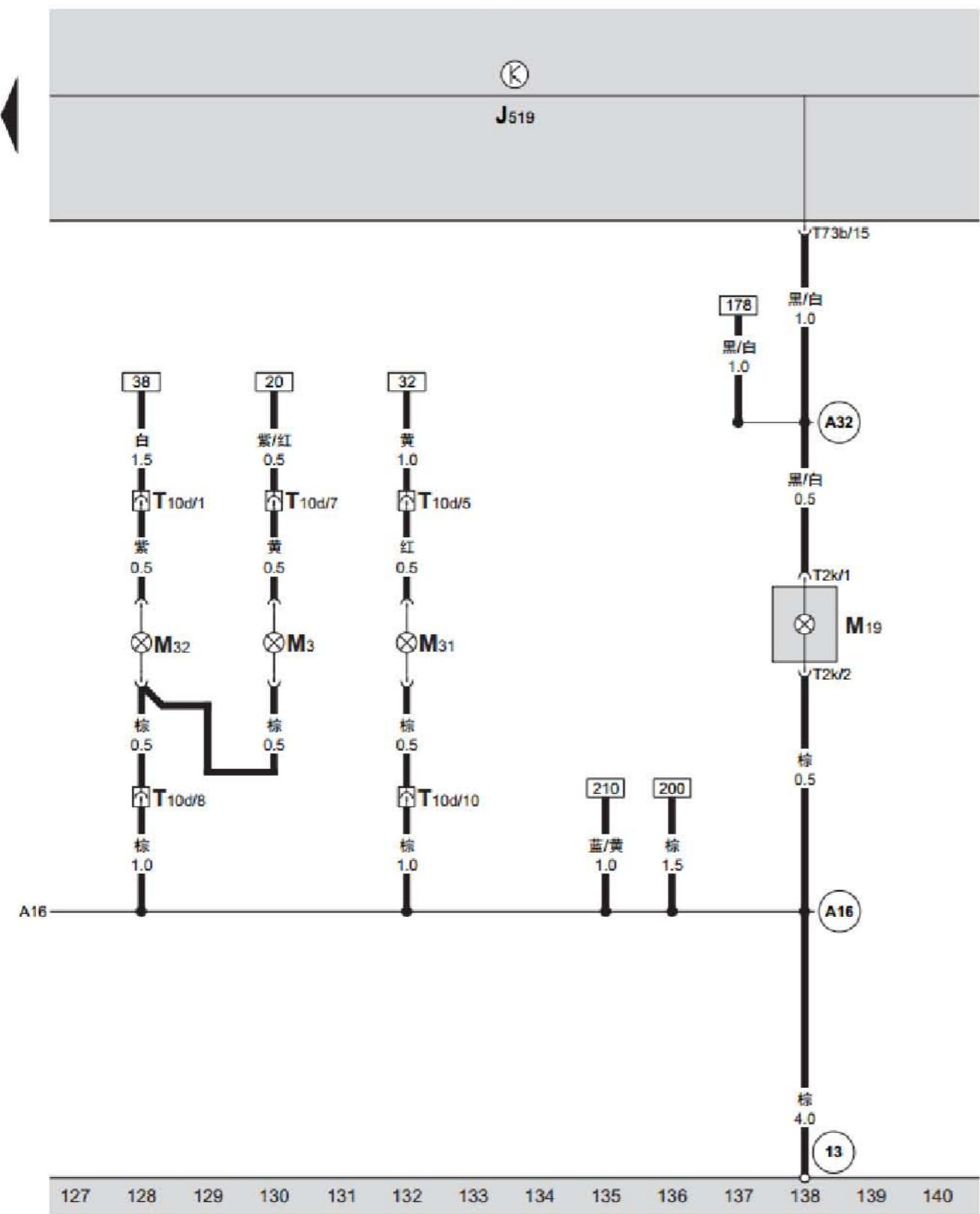
BCM 车身控制器、右侧停车灯灯泡、右侧侧面转向信号灯灯泡、右侧近光灯灯泡、右侧远光灯灯泡
