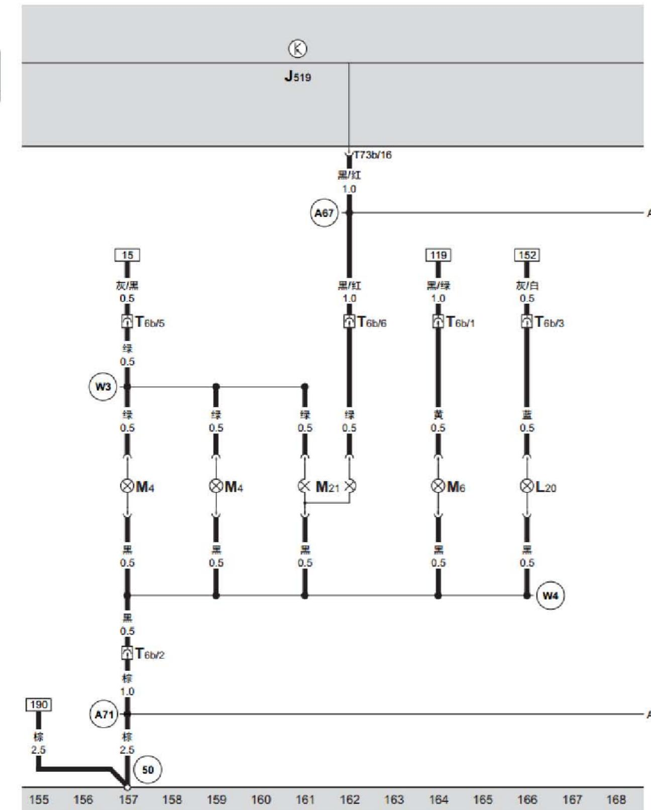
BCM 车身控制器、左侧尾灯灯泡、左后转向信号灯灯泡、左侧刹车灯和尾灯灯泡、后雾灯灯泡
