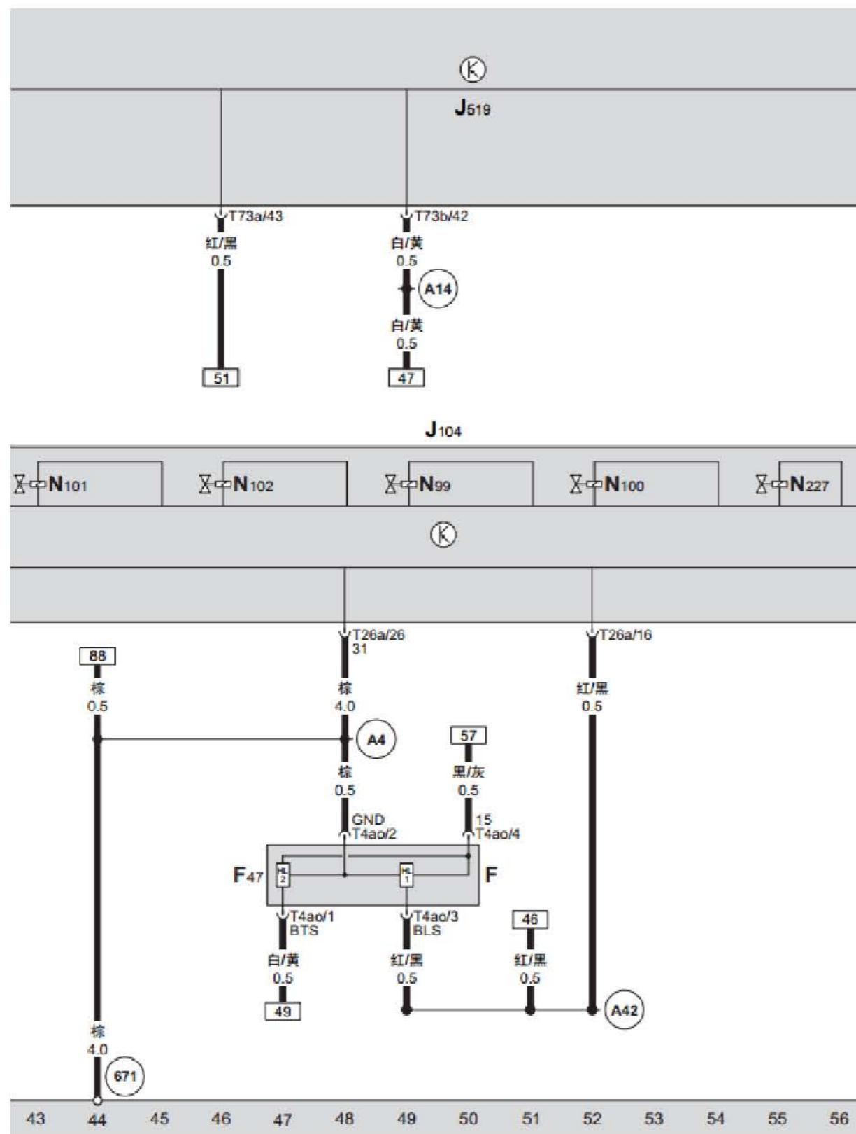
**BCM 车身控制器、ABS 控制单元、ABS 进气阀、ABS 排气阀、动态行驶调节装置高压控制阀、制动信号灯开关、制动踏板开关**
