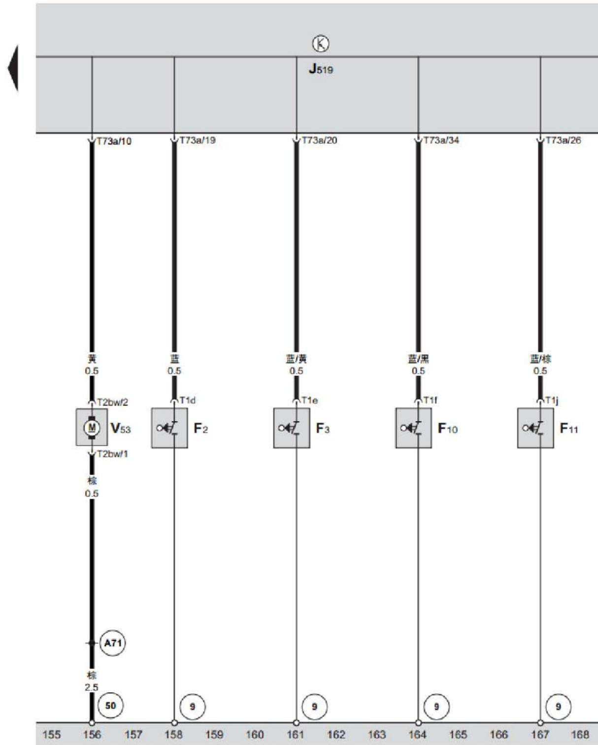
BCM 车身控制器、车门接触开关、后行李箱盖中央门锁马达
