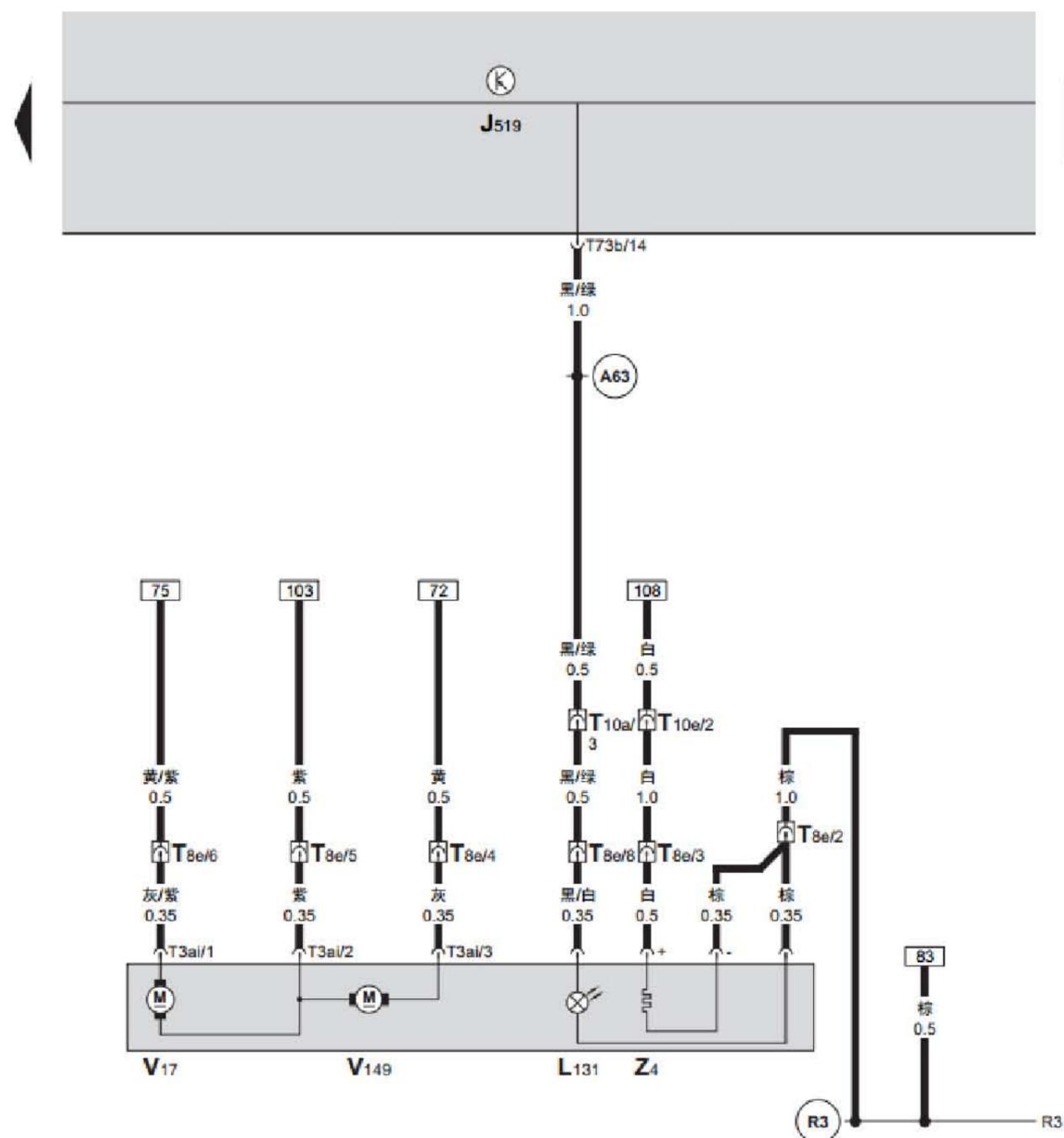
BCM 车身控制器、驾驶员侧后视镜调节马达、驾驶员侧可加热车外后视镜、驾驶员侧外后视镜转向信号灯灯泡
