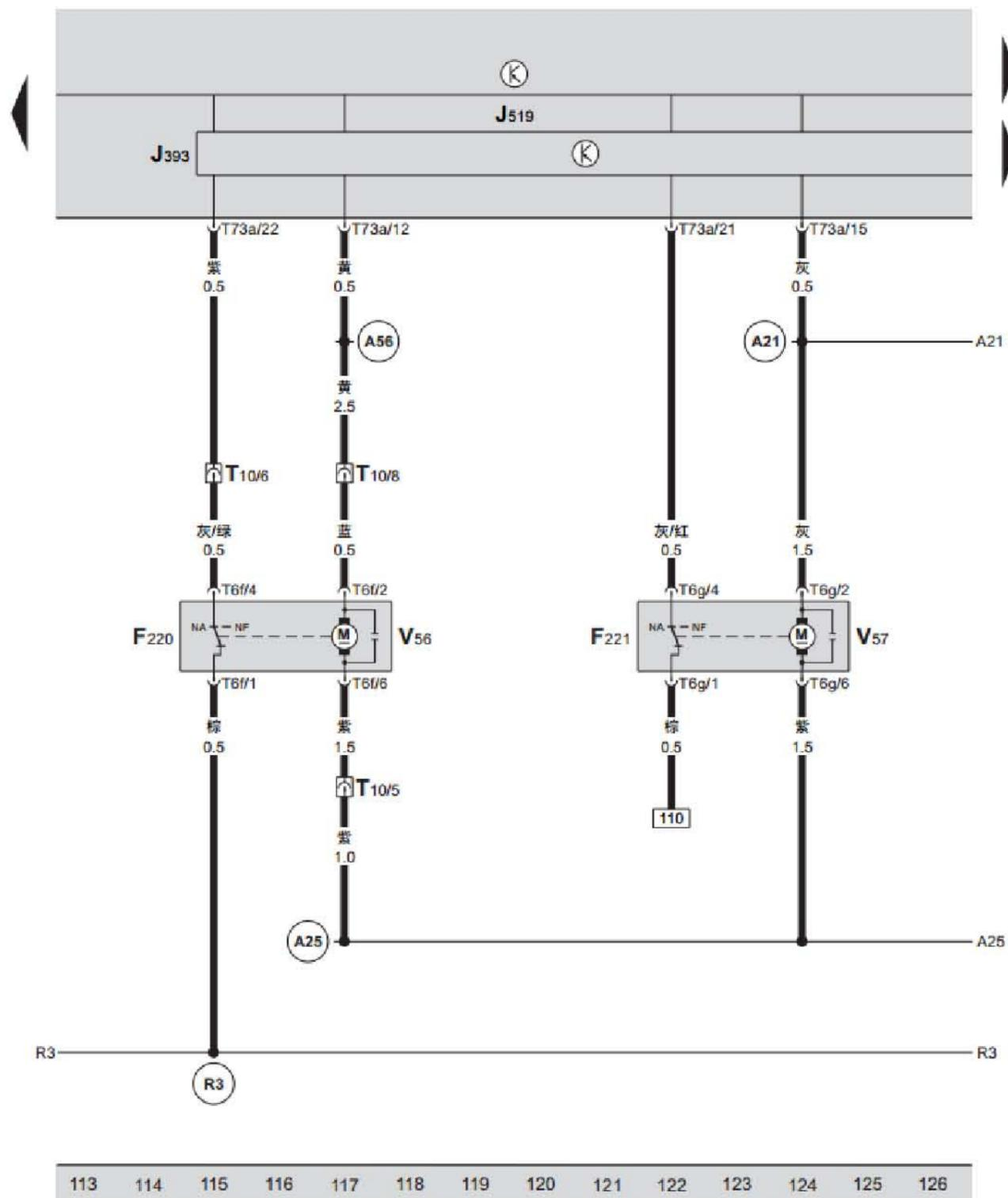
BCM 车身控制器、舒适 / 便利功能系统中央控制单元、中央门锁闭锁单元、车门中央门锁马达
