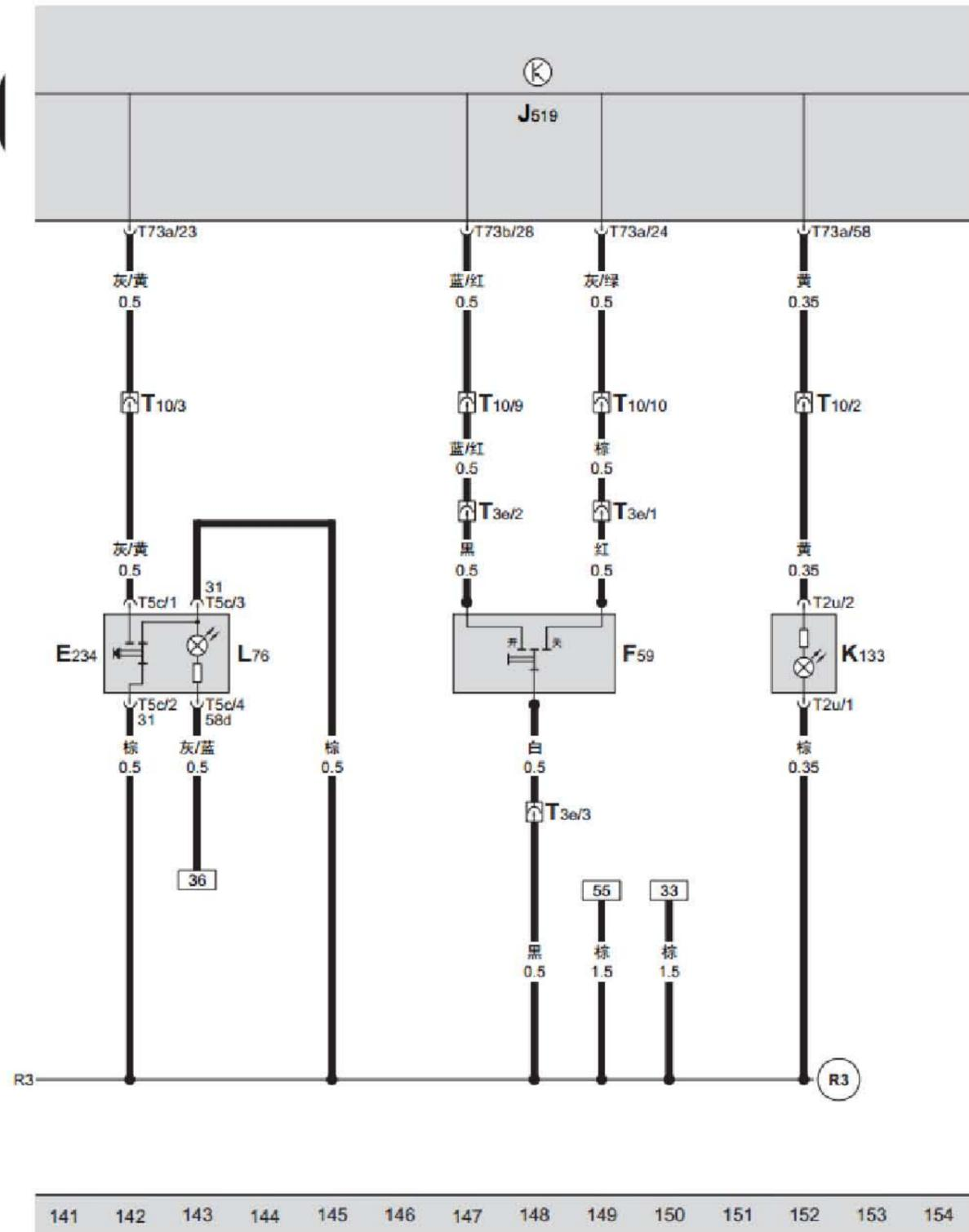
BCM 车身控制器、后行李箱盖把手开锁按钮、驾驶员侧中央门锁开关、按钮照明、中央门锁指示灯 -SAFE-
