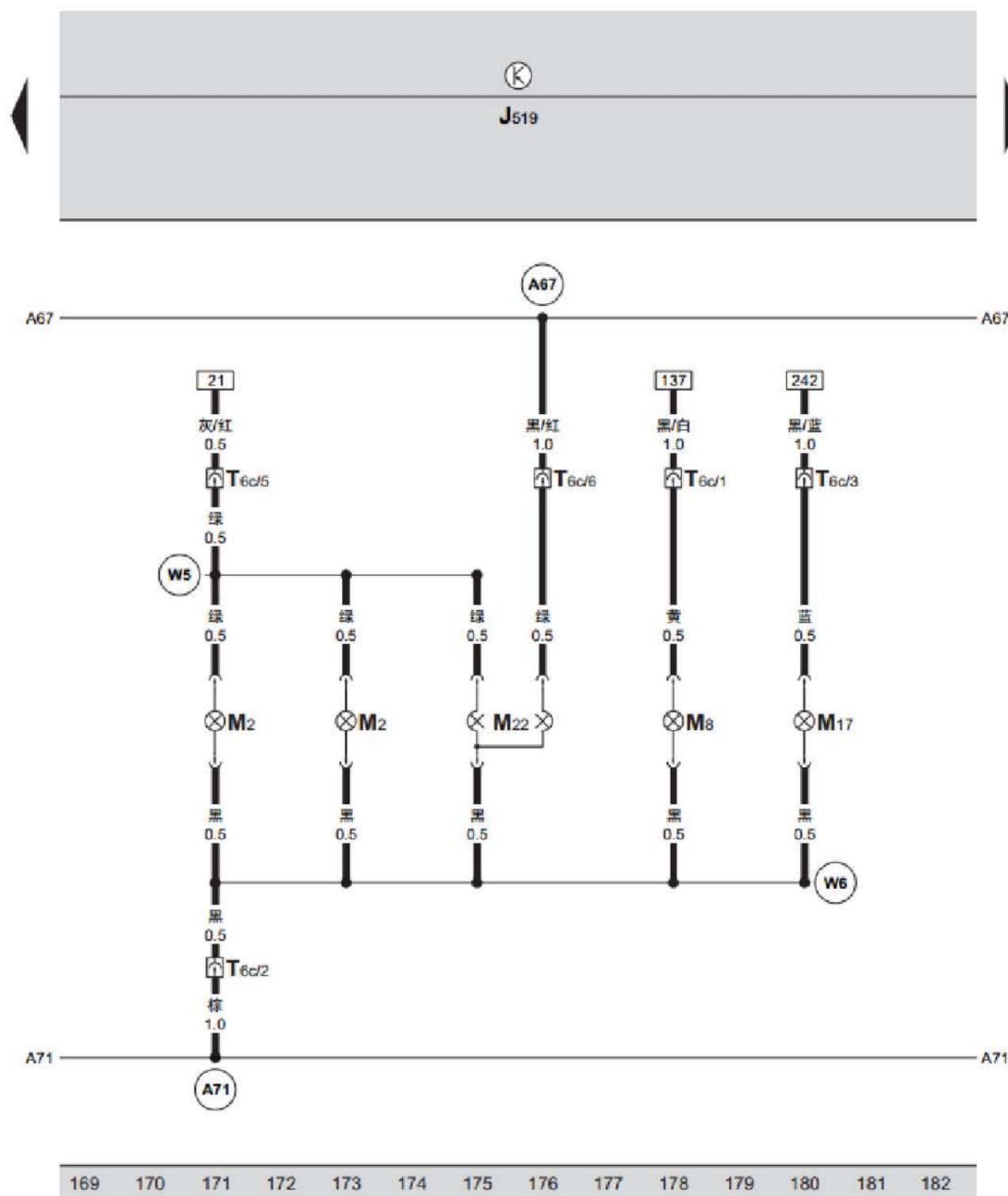
右侧尾灯灯泡、右后转向信号灯灯泡、右侧倒车灯灯泡、右侧刹车灯和尾灯灯泡
