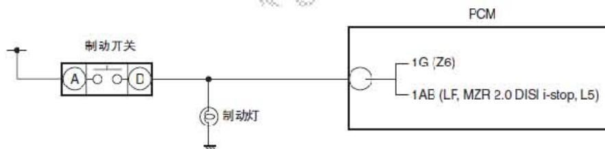
制动开关线束侧连接器
