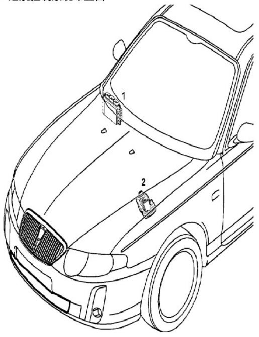
1 发动机控制模块(ECM) 2 电子控制节气门
