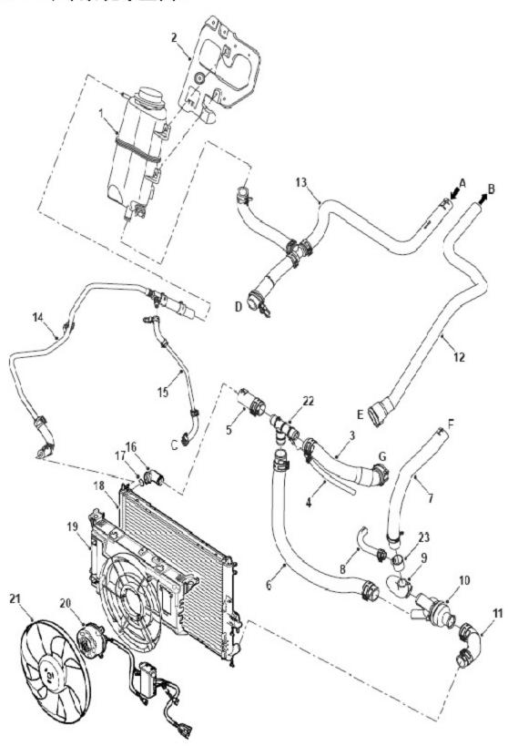
A= 暖风芯体进液口; B= 暖风芯体出液口; C= 气缸盖溢流孔; 接头D 到G,参见后续页面图例
