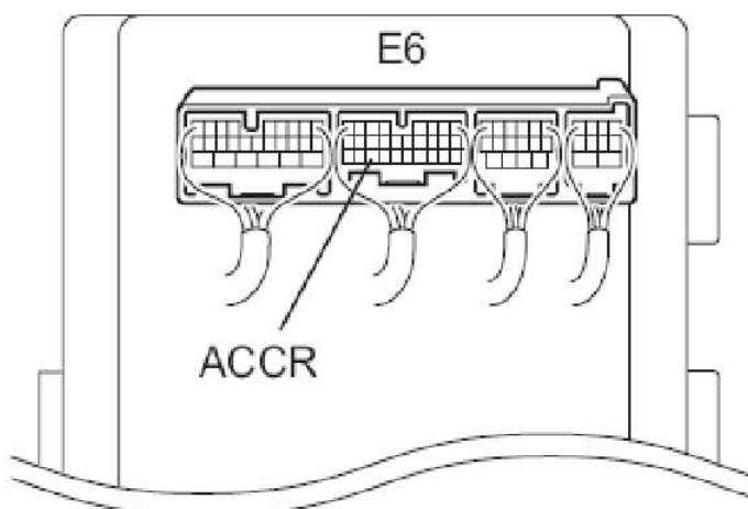
B). 根据下表中的值测量电压。
