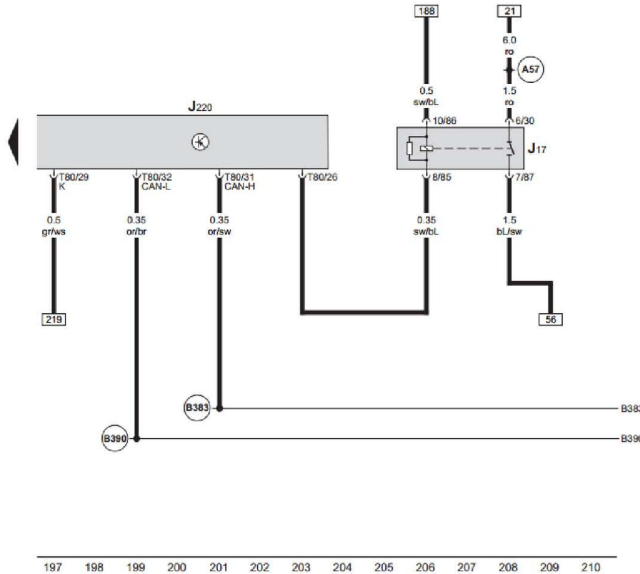
Motronic 控制单元, 燃油泵继电器
