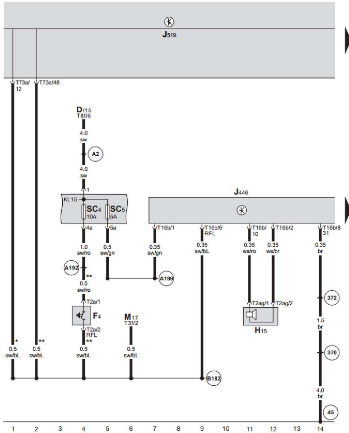
车身控制模块, 驻车辅助控制单元, 后部
