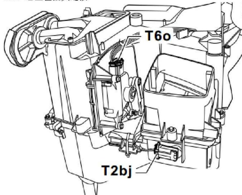
内部线束插头，在空调器底部 (仅限装备带导航系统的汽车)
