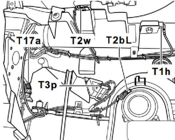
内部线束插头，在空调器右侧 (仅限装备带导航系统的汽车)
