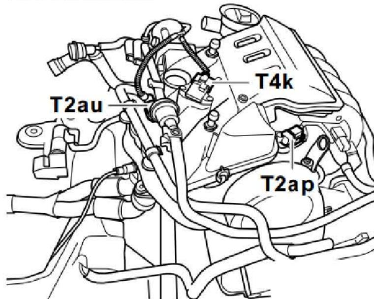
内部线束插头, 在发动机舱内 (仅限装备 1.6L 发动机的汽车)
