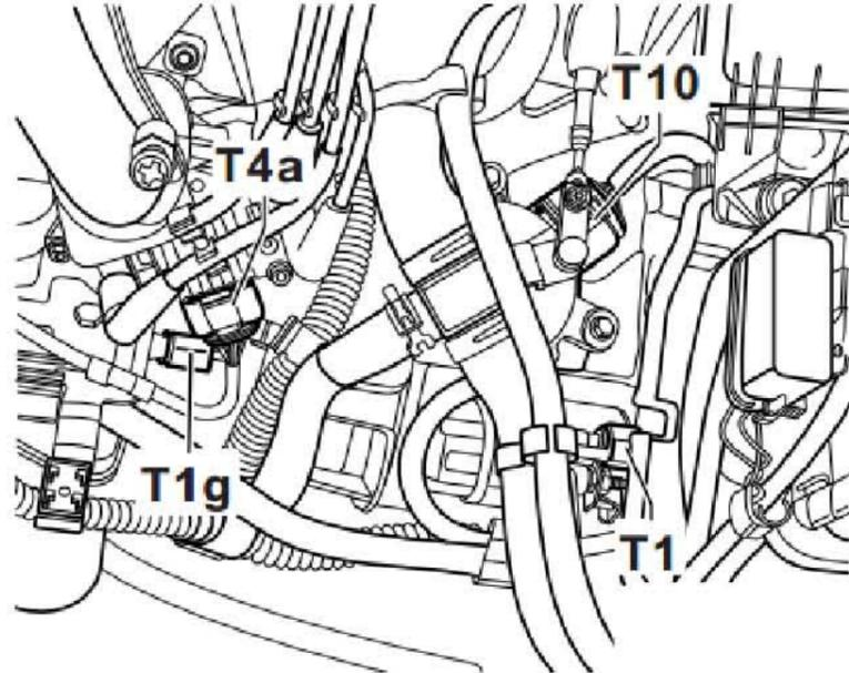
内部线束插头，在发动机舱内仅限装备 ( 2.0L ) 发动机的汽车
