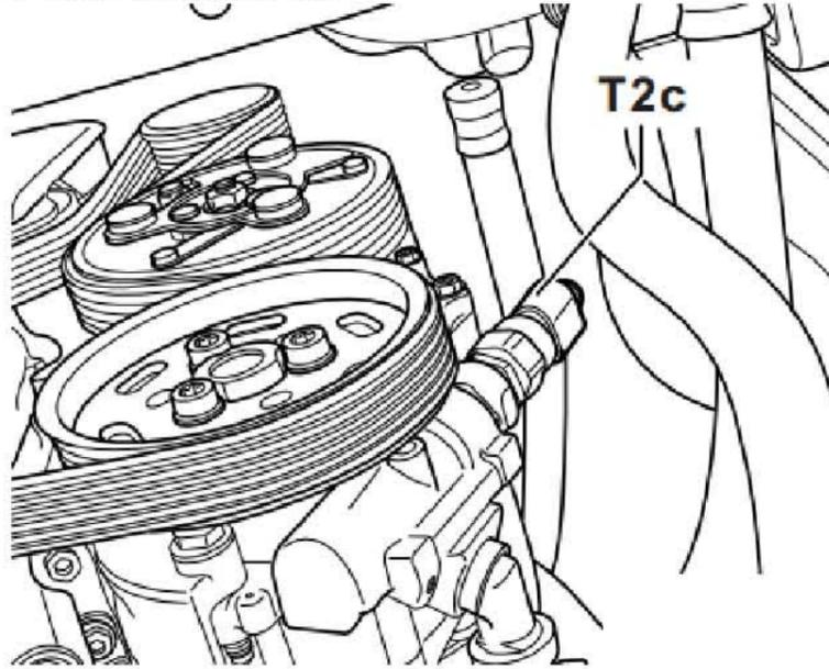
内部线束插头，在散热风扇护罩内
