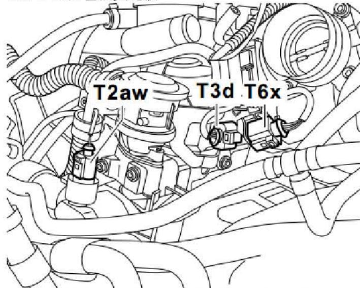
内部线束插头, 在发动机上仅限装备 发动机的汽车 ( 1.6L )
