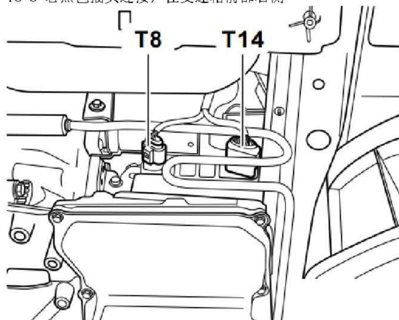
内部线束插头, 在发动机舱内 ( 仅限装备手动变速器的汽车 )
