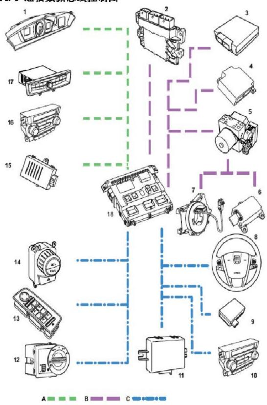
A= 中速CAN 总线; B= 高速CAN 总线; C=LIN 总线
