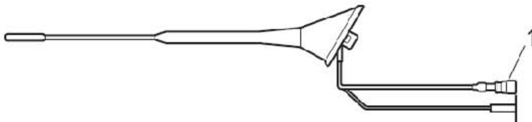
1). 车顶安装的收音机天线是一个独立式装置，经娱乐单元对其供电。
