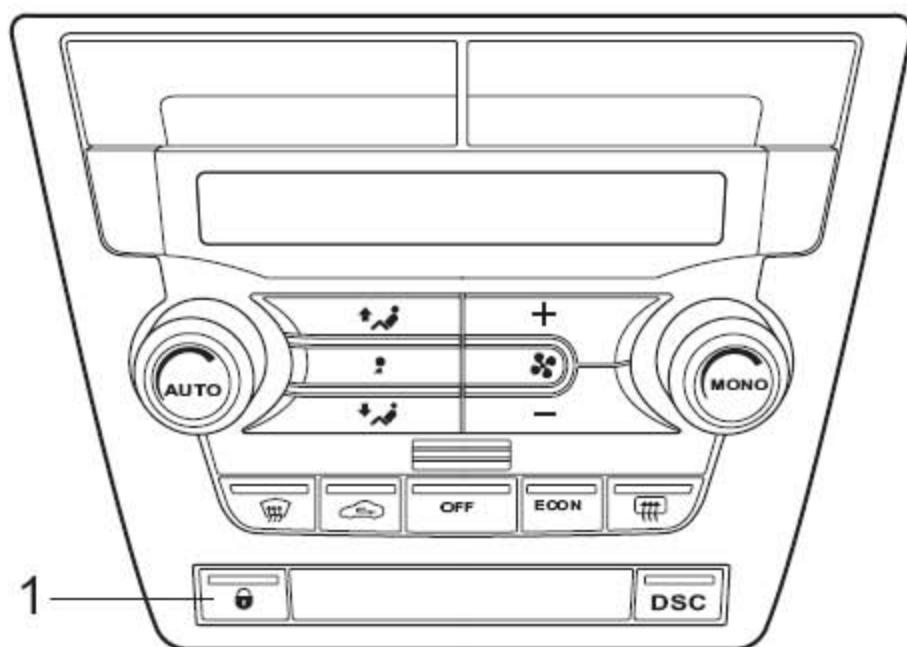
中央门锁开关是点动的开关，它位于中控台下方的空调控制器下方。当开关工作时，电路瞬间接通。BCM收到电路接通的信号后执行所有车门同时锁定或解锁请求。
