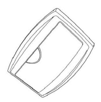
后阅读灯总成位于车顶内饰板后部的中心位置上。总成被固定在顶蓬上,小心地 将总成撬起就可以从顶蓬上拆下。整个装置用3 针脚(低配)或4 针脚(高配) 连接器将总成与车顶线束连接。
