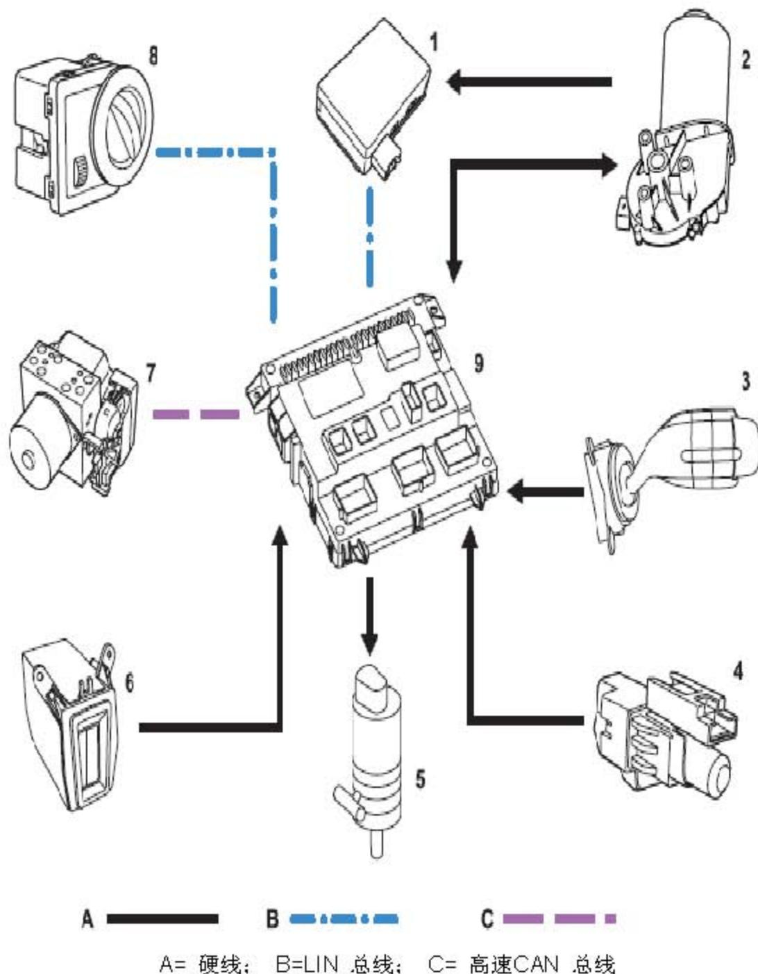
A= 硬线; B=LIN 总线; C= 高速CAN 总线
