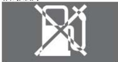
仪表通过总线从SMU 接收燃油泵继电器状态信号，当监测到出现故障时，相应的报警信息和报警声音激活。报警信息显示完后会转换成一个静态图标。并且在KL.15关掉时，报警信息会再次提醒显示。
