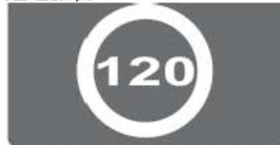
当显示的车速超过设置的车速限制时，报警信息和声音报警激活。报警信息显示完后会转换成一个静态图标。
