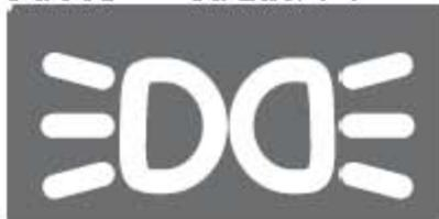
仪表通过总线从SMU 接收信号。当监测到点火钥匙拔出，车灯未关闭，驾驶员门打开时，报警激活，并伴有声音报警重复提醒20 秒。
