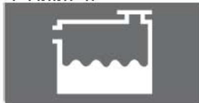
仪表通过总线信号从SMU 接收信号，当监测到发动机冷却液位低时，报警信息和报警声音触发。报警信息显示完后会转换成一个静态图标。并且在点火开关关闭时，报警信息会再次提醒显示。
