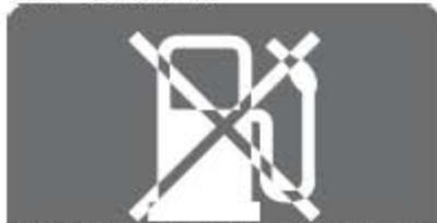
仪表通过总线信号从SMU 接收信号，当监测到惯性开关被触发时，报警信息和报警声音触发。用于提醒驾驶员燃油已经被切断。
