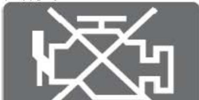
在启动过程中，如果点火钥匙验证失败，则SMU 不闭合启动电机的继电器，并通过总线将钥匙无效信号发给仪表。仪表显示对应的报警信息和声音报警。报警信息显示完后，会转换成一个静态图标。
