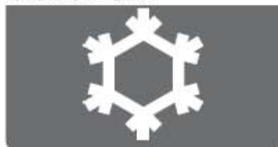
仪表通过总线信号从BCM 接收外界环境温度信号。当温度低于设定的阈值(3 ℃)时，报警触发，并伴有报警声音。报警信息显示完后会转换成一个静态图标。
