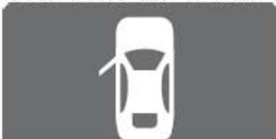
仪表通过总线从SMU 接收车门，发动机舱和行李箱盖的状态信号。当有一个或多个车门/盖未关好时，通过一个报警信息图标综合反映，并伴有声音报警。报警信息显示完后会转换成一个静态图标。以驾驶侧车门未关好为例：当状态改变时，静态图标会进行更新，且声音报警会再次激活。
