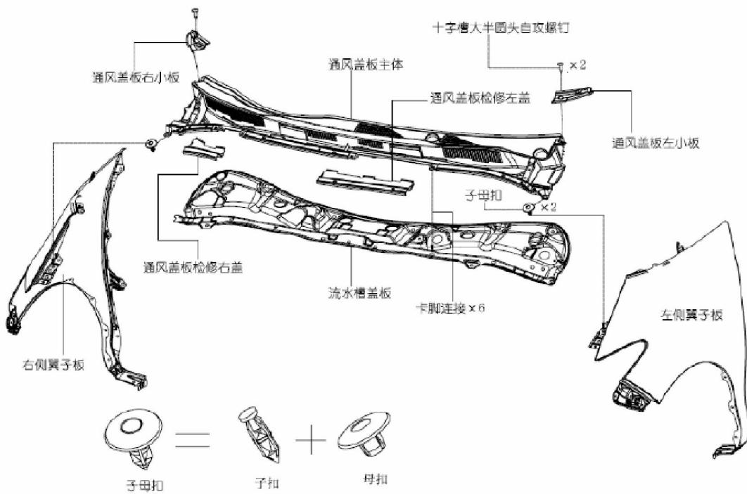
➤ 通风盖板安装在车身翼子板上面。拆卸时按以下步骤进行：
