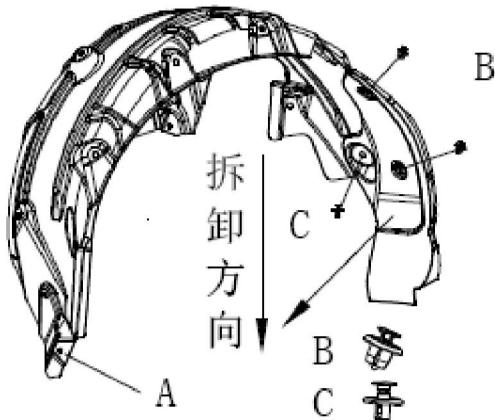
➤后轮挡泥板的拆卸按以下步骤进行：
