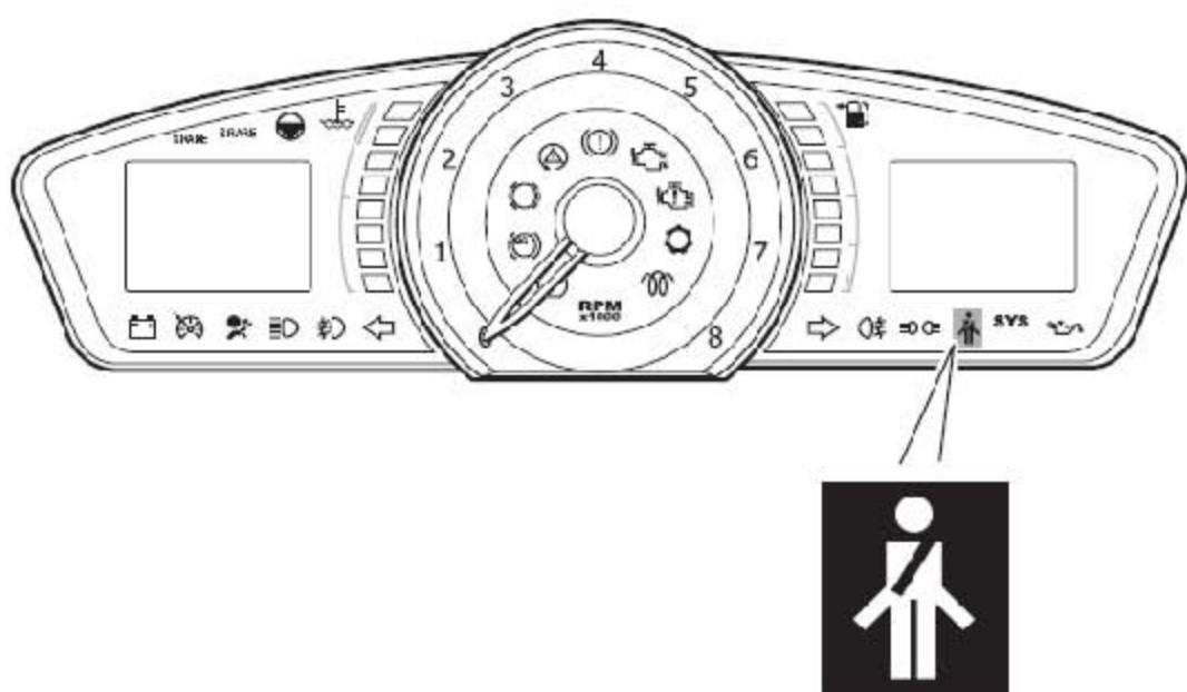
前排座椅安全带锁扣集成了安全带未系报警开关，通过SRS ECU 连接到组合仪表。如果车辆运动，而安全带却没有系紧，则安全带报警触发。警告信息包括一个声音报警和一个仪表盘上闪亮的警示灯报警。对于某些车辆规范规定，在没有乘客的情况下，为了避免引起不必要的警告，在乘客座位泡沫内部安装一个压力传感器。如果有乘客，但是压力传感器没有被激活，那么即使乘客没有系安全带，安全带警告也不会被触发。
