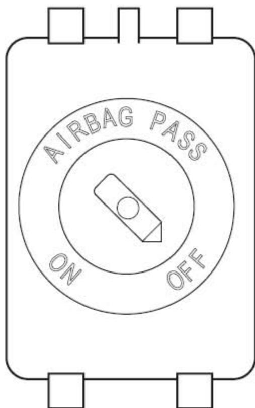
如果在乘客座位上安装儿童安全座椅，则必须将乘客侧气囊禁用开关处于“OFF”档。以防引爆的安全气囊伤害到儿童。安全气囊禁用开关位于仪表板的右侧，当乘
