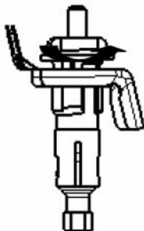
将纽扣逆时针旋转一定的角度，即可将开启拉索接头取下，再将各个安装卡扣逐个取下，即可将开启拉索卸下。
