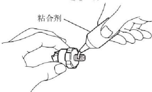
B). 用24mm长套筒扳手，安装机油压力开关。
