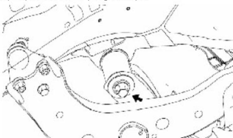
注：用加长杆穿过摆臂套管，进行拆卸。
