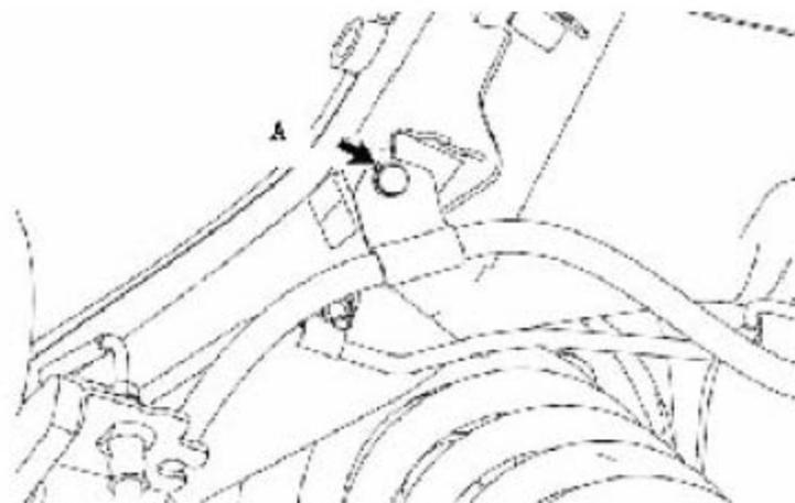
D). 安装新的 E 型卡, 连接拉索与制动钳连接端。
