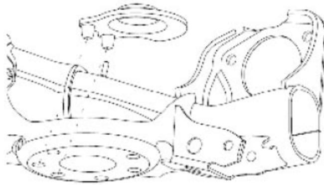
3). 安装螺旋弹簧上缓冲垫并使其缺口与弹簧末端相配合。
