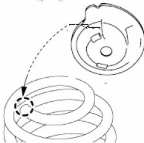
C). 将螺旋弹簧安装到后扭转梁上。
