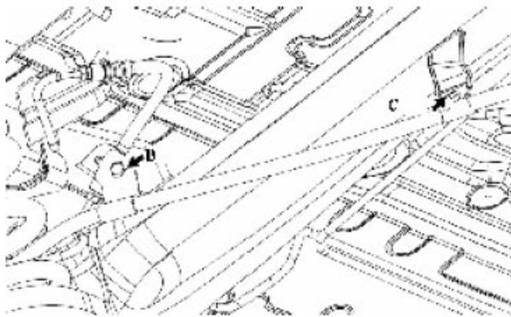
B). 安装左后驻车拉索支架 2。如图示 B。
