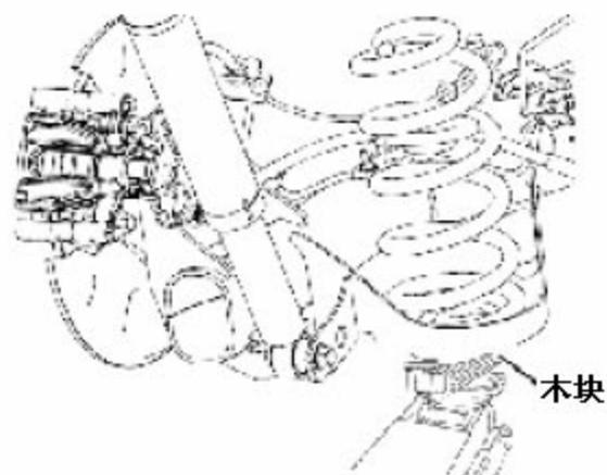
B). 拆除螺栓、螺母并分离左后减振器。
