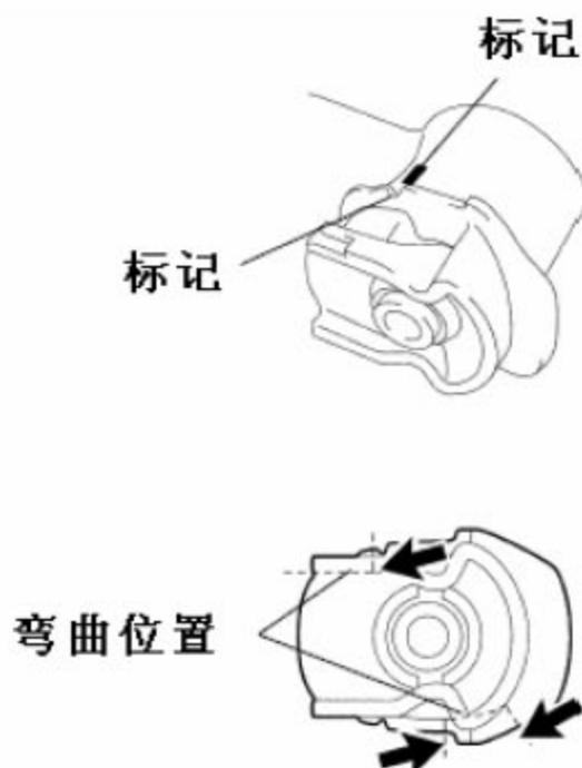
C). 使用专用工具从后扭转梁上拆下衬套。
