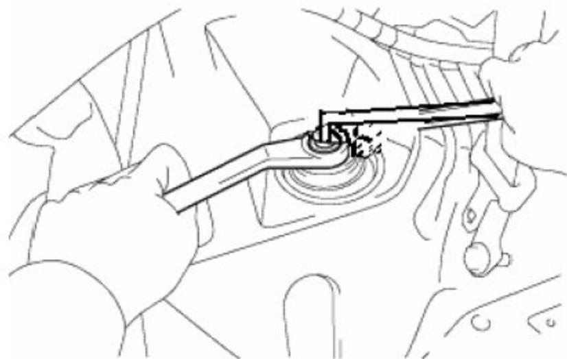
D). 拆除后减金属垫片、支撑垫总成。
