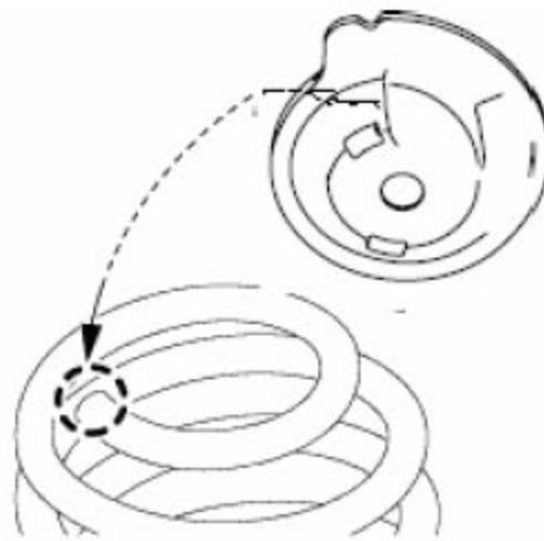
4). 将螺旋弹簧安装到后扭转梁上。
