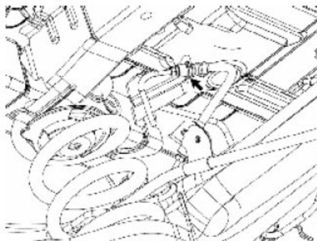
B). 拆下 E 型卡，使制动软管与车身油管固定支架分离。
