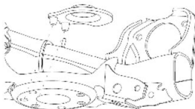
B). 安装螺旋弹簧上缓冲垫并使其缺口与弹簧末端相配合。
