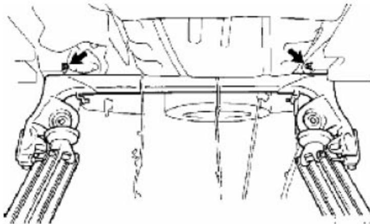
16). 拆除后扭转梁上制动管路。
