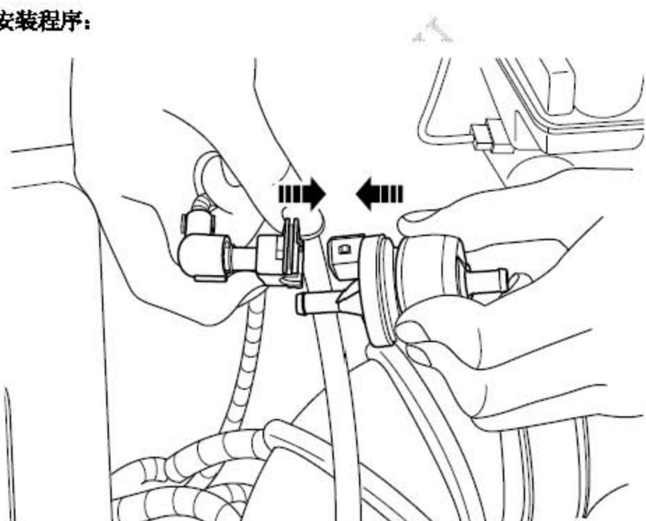
1). 连接碳罐电磁阀线束连接器。
