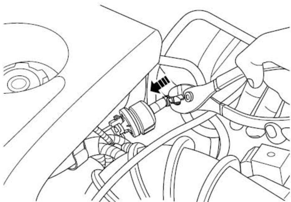
2). 连接碳罐电磁阀真空管。
