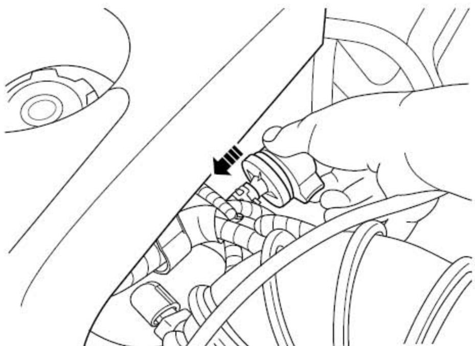
3). 将碳罐电磁阀安装到固定支架上。
