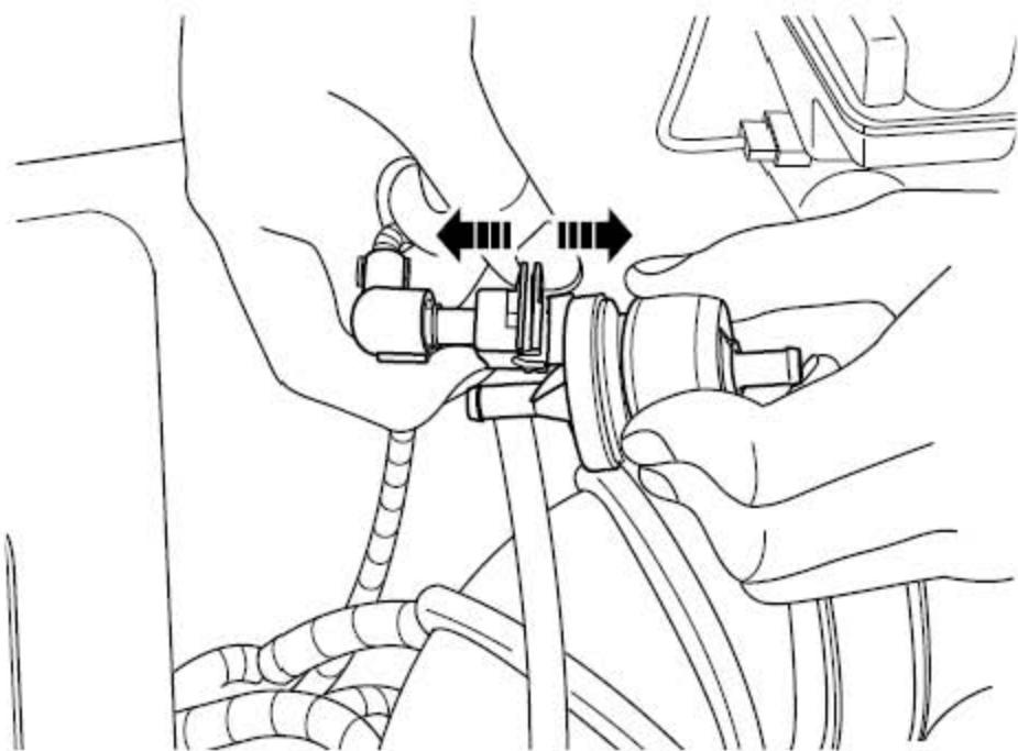
4). 断开碳罐电磁阀线束连接器。
