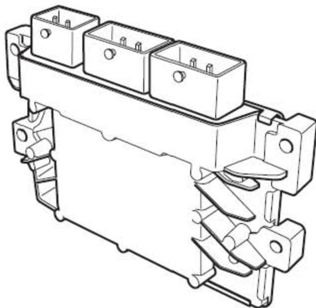
ECM安装在铝盒中，以便散热，并保护其不受电磁干扰。ECM 安装在一个支架上，此支架是蓄电池支架的一部分，由两个螺母和两个螺栓固定。三个连接器通过旋转夹连接并固定在ECM上。
