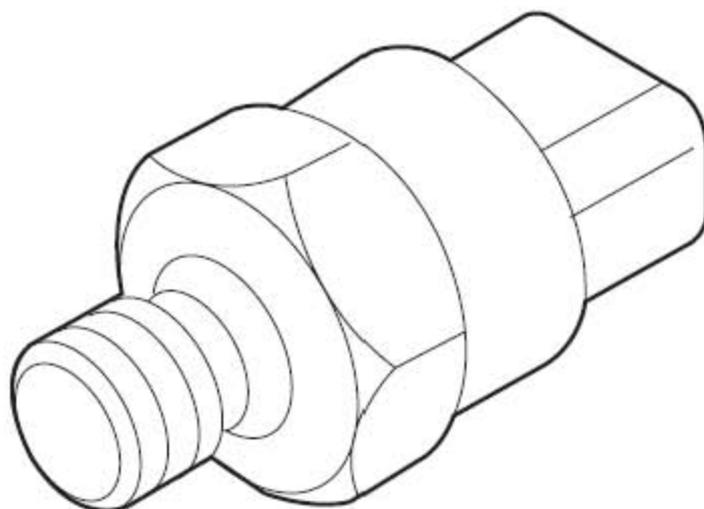
PAS泵由发动机曲轴驱动, 通过皮带传动。将方向盘转至全锁止位置, 相比直线向前行驶, 这将给发动机带来非常大的附加负载。为了避免发动机停机或怠速时转速过低, 与转向液压泵高压端连接的传感器发出PAS 负载信号。传感器位于泵体的出口接头上, 并通过连接器EM009 与发动机线束连接。
