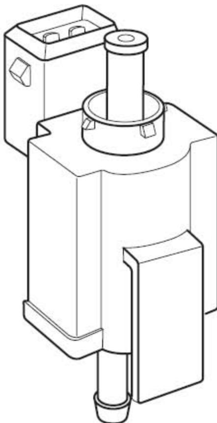
增压控制电磁阀，通过连接器EM013 与发动机线束连接，安装在空气滤清器的右侧，用一个夹具固定。电磁阀接受来自进气软管和涡轮增压器的压力输送。一个出气软管与涡轮增压器排气门连接。
