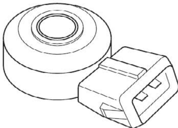
在气缸体后侧，3号和4号缸之间安装了一个压电陶瓷的爆震传感器，通过连接器EM021与发动机线束连接。
