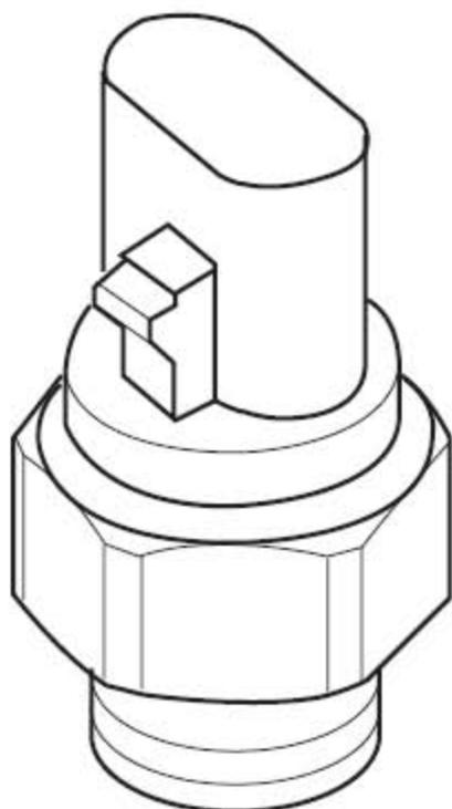
A/C 压力开关位于发动机舱右侧，A/C高压制冷管上，通过连接器EB034与发动机舱线束连接。其通过完成ECM和车身之间两个接地通路来对系统中的不同压力采取三种压缩机的控制策略。
