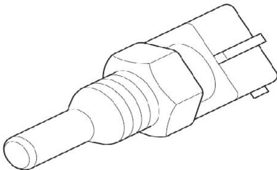
ECT 传感器位于缸盖上冷却液出口弯管上，VCT 发动机上，通过连接器EM014 与发动机线束连接，涡轮增压的发动机上，通过连接器EM015 连接。ECT 传感器包括一个与发动机冷却液接触的NTC 热敏电阻，此电阻是分压电路的一部分，分压电路包括一个整流的5V 电源，一个固定阻值电阻（ECM 内）和一个随温度变化的电阻器（ECT 传感器）。
