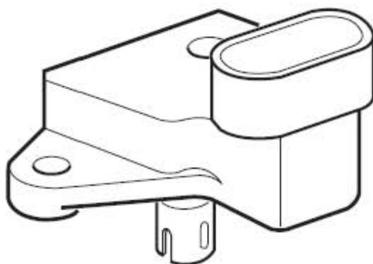
涡轮增压发动机进气系统安装了两个TMAP 传感器。TMAP 传感器1 安装在节气门前的进气管上，用来确定经过节气门的压力，通过连接器EM010 与发动机线束连接。TMAP 传感器2 安装在进气歧管上，节气门的另一侧，用两个螺钉固定，用来测量进气歧管内的空气温度和压力，通过连接器EM005 与发动机线束连接。
