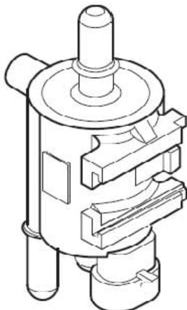
炭罐控制阀位于进气歧管的下侧，通过支架安装在气缸体上，并通过软管与进气歧管和炭罐连接。炭罐控制阀包括一个电磁控制阀，通过连接器EM060与发动机线束连接，通过12V PWM信号由ECM控制。
