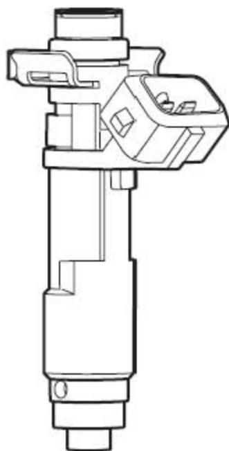
进气歧管端口内安装了4个喷油器，在底座用O型圈密封。喷油器通过连接器C0522 (IL002)，C0523 (IL003)，C0524 (IL004) 和C0525 (IL005)，与喷油线束连接。喷油器包括一个枢轴型阀针和座，一个用于克服回位弹簧开启阀针的电磁绕组。电磁绕组在20 °C (68 °F) 条件下，电阻值为13-16 Ω。VCT发动机安装传输速度达137 克/秒的喷油器。涡轮增压发动机安装传输速度达187 克/秒的高流速喷油器，以便当涡轮增压器增压高时，可以维持合适的空燃比 (AFR)。
