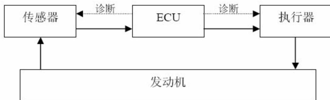
图 2.1 发动机电控系统的组成
