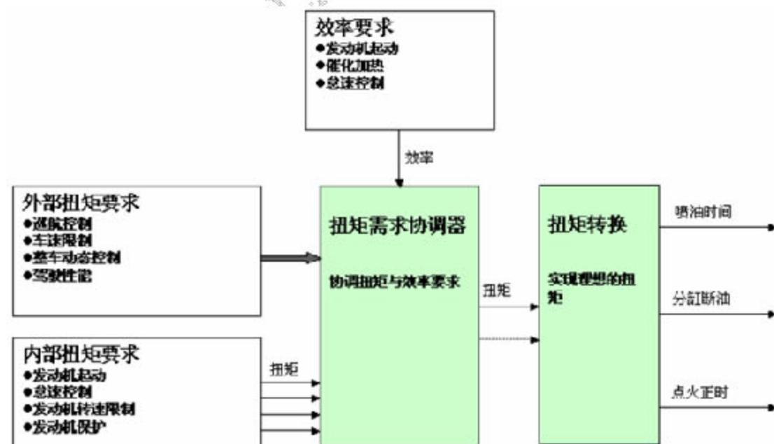
图 2.3 M7 以扭矩为基础的系统结构
