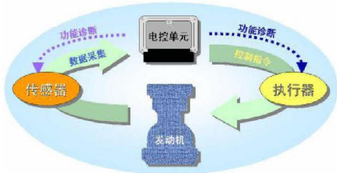
图 2.1 电喷系统故障诊断原理图
