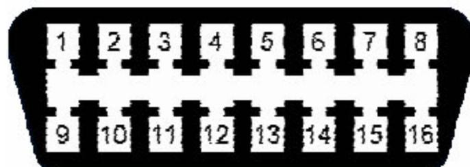
图 2.5 ISO9141-2 标准诊断接头
