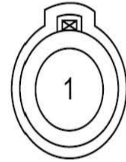
压缩机线束连接器(JL4G15-G) EO06
