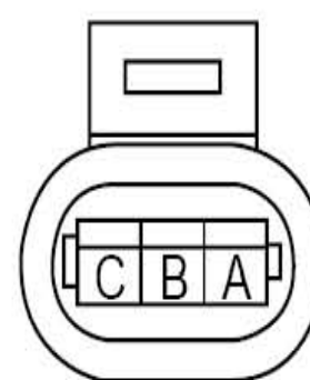
点火线圈线束连接器(JL4G15-G) EO19
