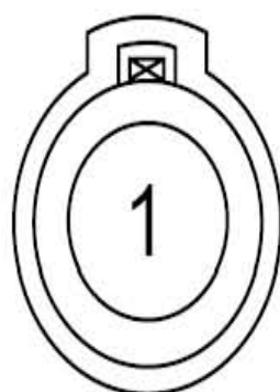
启动机线束连接器(JL4G15-G) EO18
