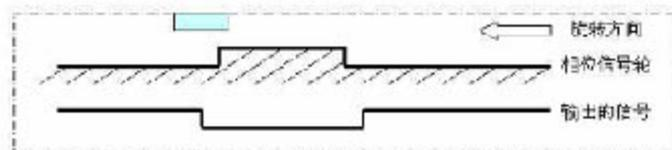
图 3-34 相位传感器工作示意图(一)
