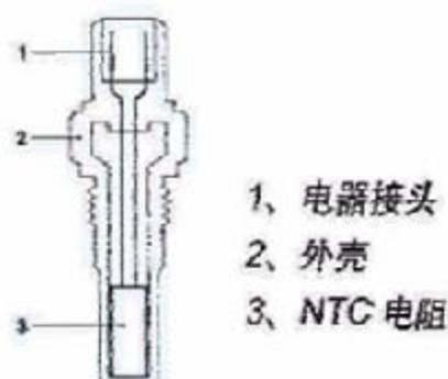
图 3-9 冷却液温度传感器剖面图
