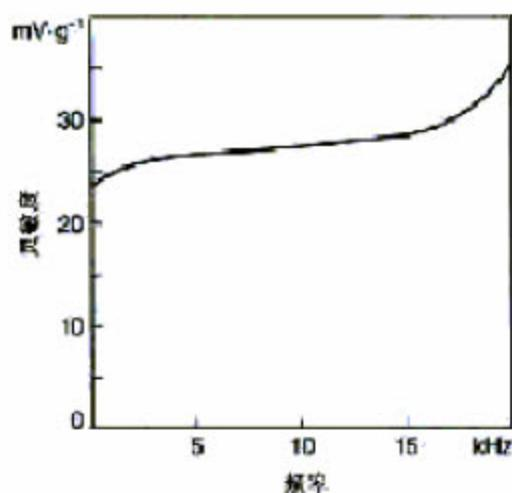
图 3-15 爆震传感器频率响应特性曲线
