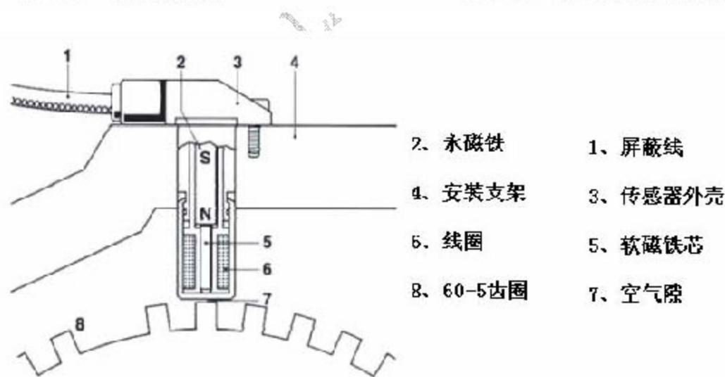
图 3-25 转速传感器剖面图
