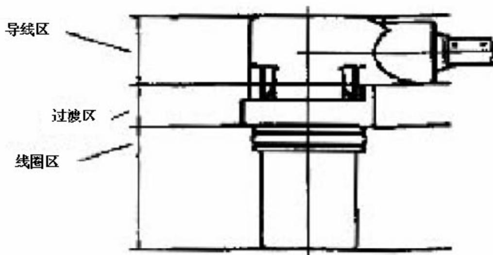
图 3-28 转速传感器的三个温度区
