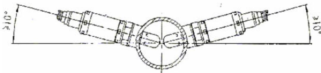
图 3-22 氧传感器的安装型式
