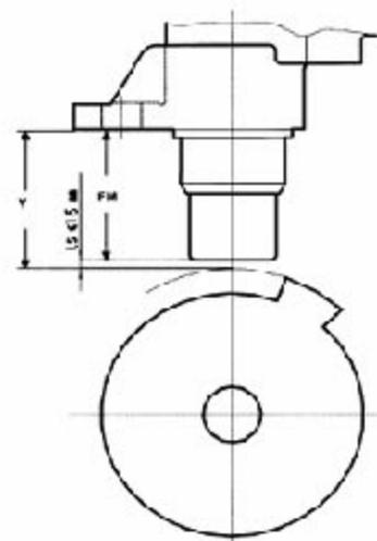
图 3-35 相位传感器工作示意图(二)
