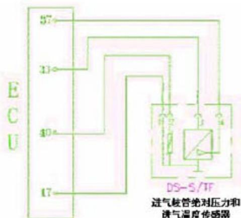
图 3-2 进气压力温度传感器电路图
