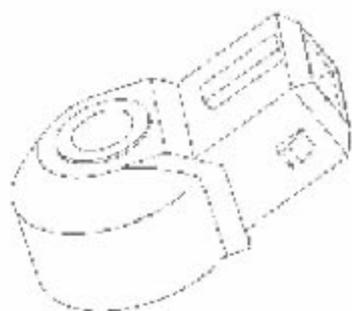
图 3-11 不带电缆的爆震传感器
