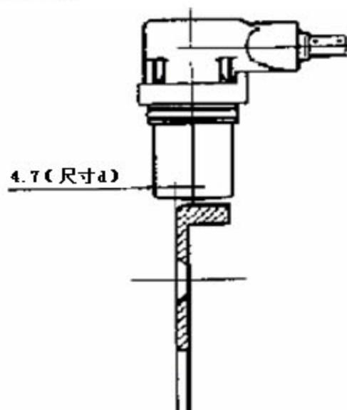
图 3-29 转速传感器的安装
