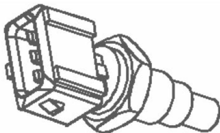
图 3-7 冷却液温度传感器
