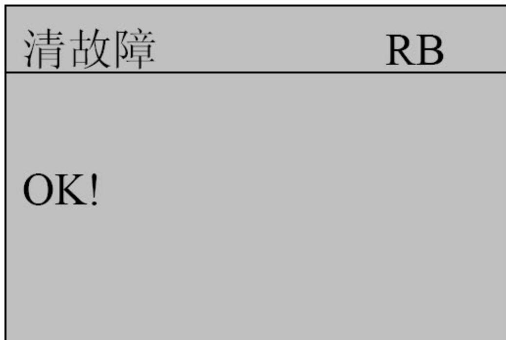
显示“OK”，表示“清故障”操作结束，按“确认”键返回“自诊断”版面。
