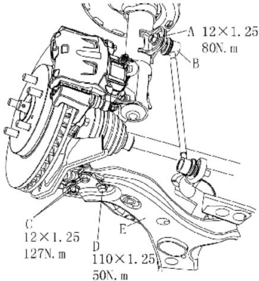
5) 将稳定杆拉杆与减震器对接, 安装连接处的六角法兰面导向螺母 (A), 打紧力矩至规定值。
