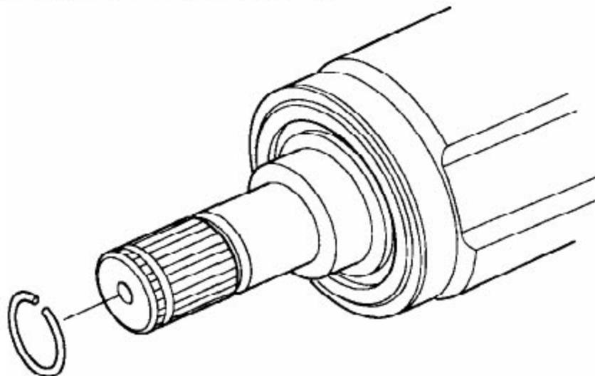
2).用溶剂或制动器清洁剂彻底清洗半轴与差速器的接触区，然后用压缩空气吹干。将半轴的内球笼端(A)插入差速器(B)内，直至定位环(D)在凹槽(E)内锁止。
