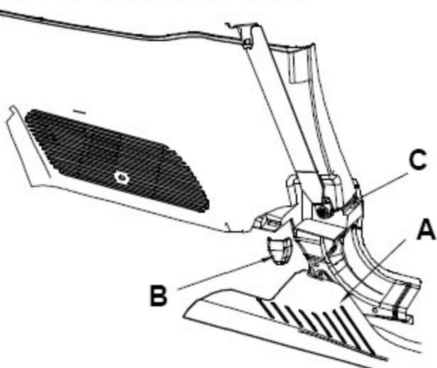
3).脱开导向件外盖 A 的卡脚，然后拆卸上固定点螺栓。螺栓拧紧力矩 40N.m。
