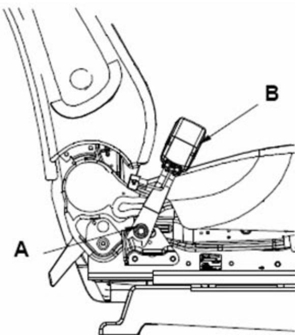
11).按与拆卸相反的顺序进行安装，以要求的力矩拧紧螺栓；确保安全带接插器插接正确：
