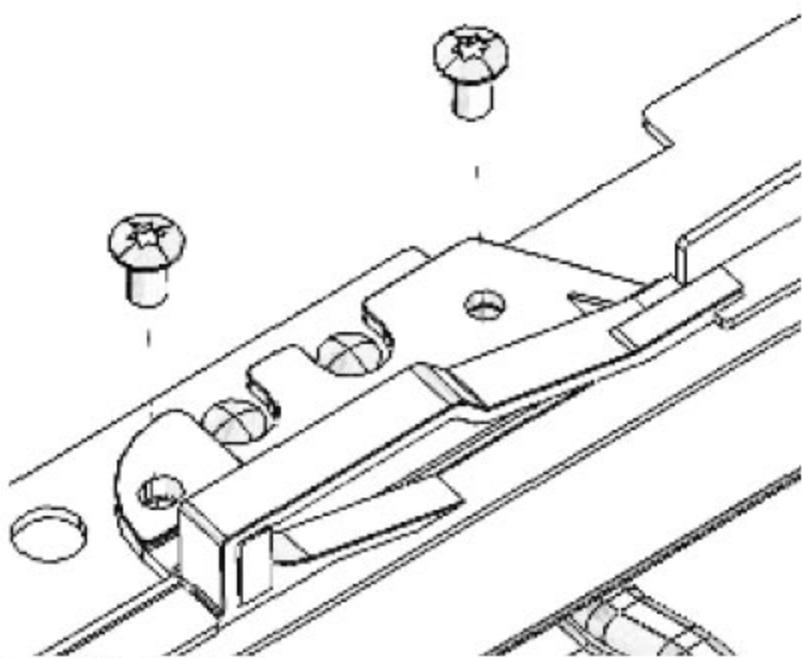
以同样的方式卸下右前导向块。
