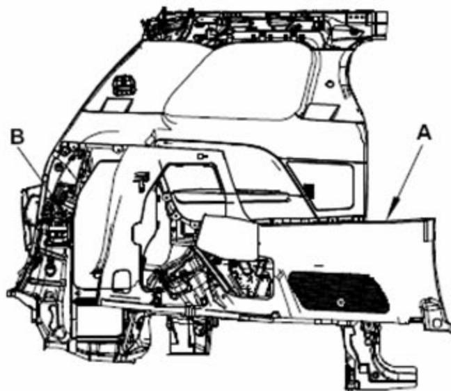
7). 按与拆卸相反的顺序进行安装，以要求的力矩拧紧螺栓；在安装下固定点螺栓前，确认安全带没有扭曲或打结；检查卷收器锁止机构的功能（见检测部分）。
