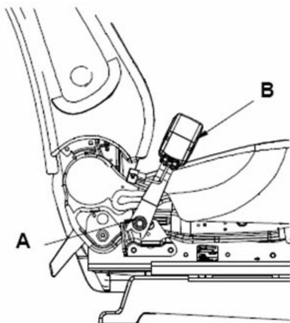
11). 按与拆卸相反的顺序进行安装，以要求的力矩拧紧螺栓；确保安全带接插器插接正确；
