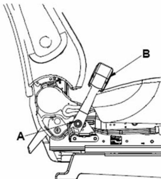
8). 按与拆卸相反的顺序进行安装，以要求的力矩拧紧螺栓；在安装上、下固定点螺栓前，确认安全带没有扭曲或打结；检查卷收器锁止机构的功能（见检测部分）
