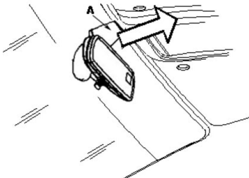
2) 如图, 脱开线束接插件 B, 按图中箭头方向推支架, 拆除内后视镜 :
