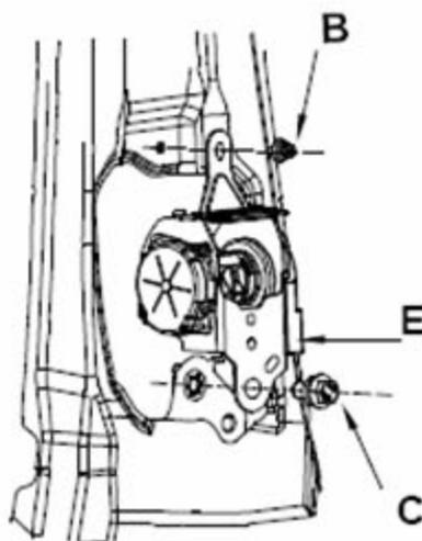
7). 拆卸高度调节器的两个固定螺栓 A, 螺栓拧紧力矩 35N.m。拆除高度调节器 B。
