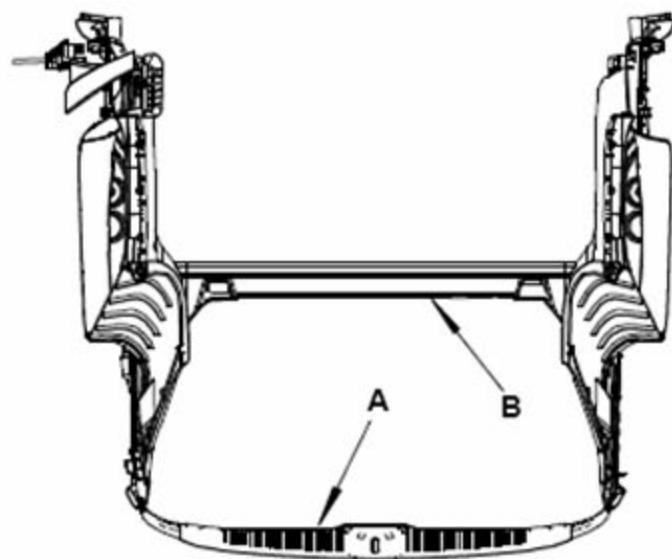
6).接着参考内外饰的拆解方法拆掉后侧围本体 A，拆掉卷收器安装螺栓 B，螺栓拧紧力矩为 40N.m。
