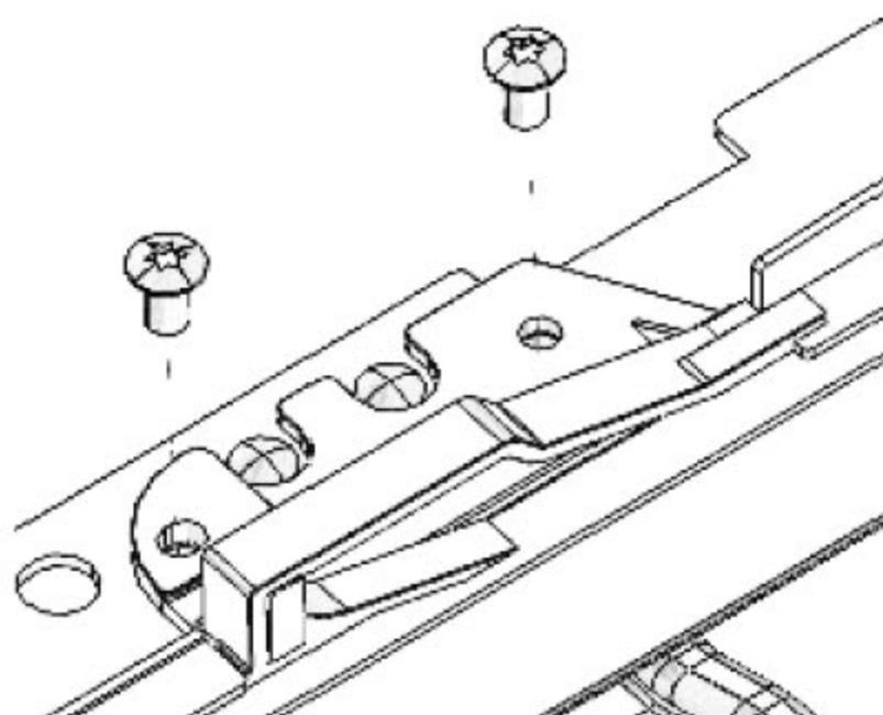
以同样的方式卸下右前导向块。
