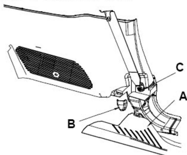
3). 脱开导向件外盖 A 的卡脚，然后拆卸上固定点螺栓。螺栓拧紧力矩 40N.m。
