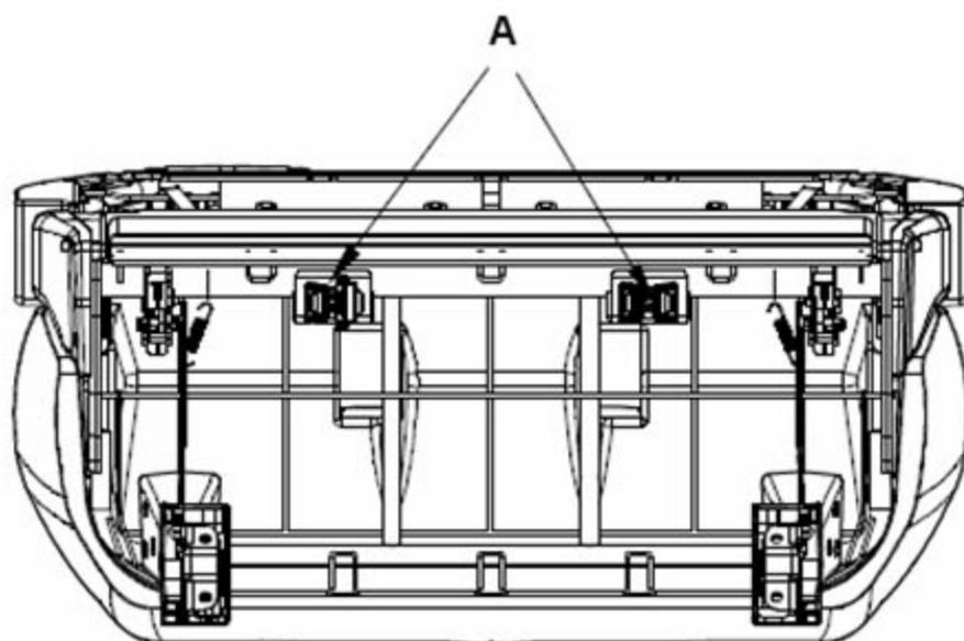
3). 同前排和中排一样，脱开导向件外盖的卡角，拆掉导向件上的安装螺栓，螺栓拧紧力矩为 40N.m。
