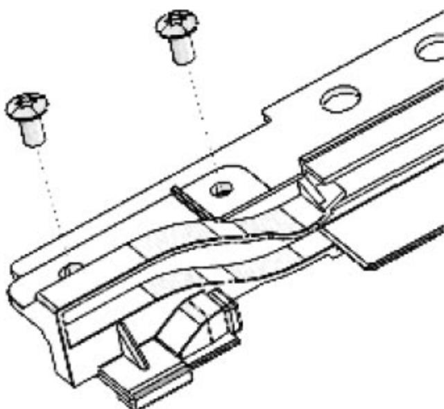
以相同的方式拆卸右后导向块。
