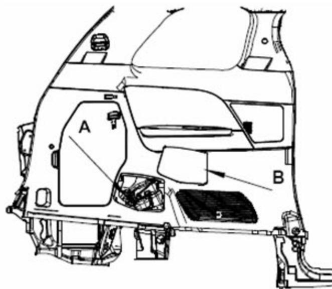
5).参照内外饰拆卸方法拆掉后围踏板总成 A、行李箱盖板和后备箱前护板 B
