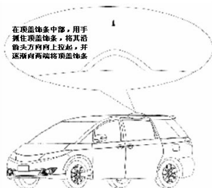
图 1-1 顶盖饰条安装/拆卸总示意图
