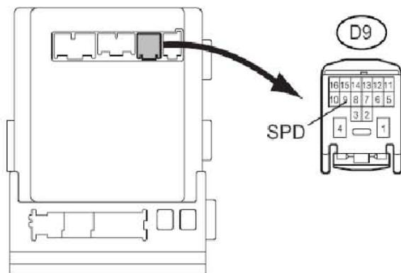
线束连接器前视图：（至接线连接器）
