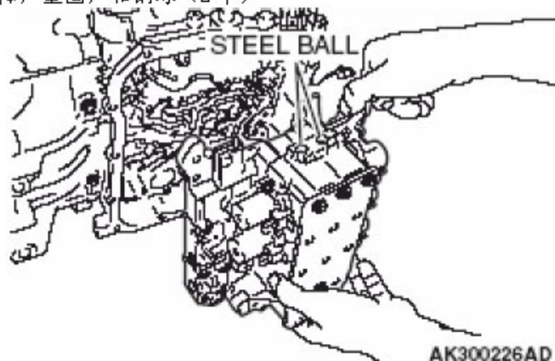
14).从连接器上拆除卡扣。将连接器推入驱动桥体内并拆卸电磁阀(solenoid valve harness)。
