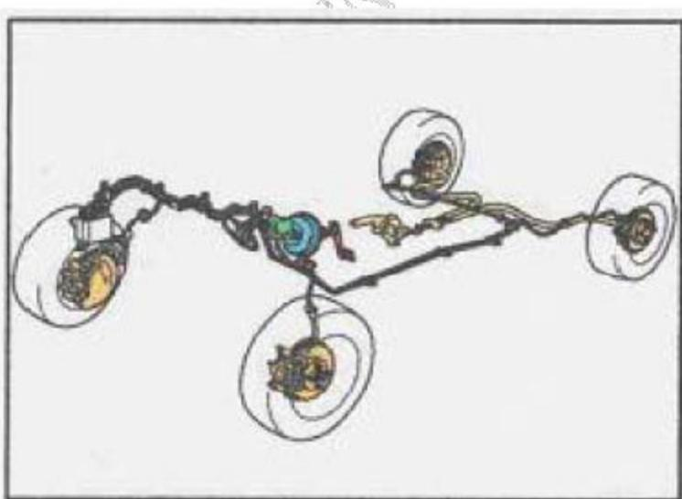
3). 在行车前和行驶中,ABS ECU 不断地监控所有与 ABS 相关的电气元件是否工作正常
