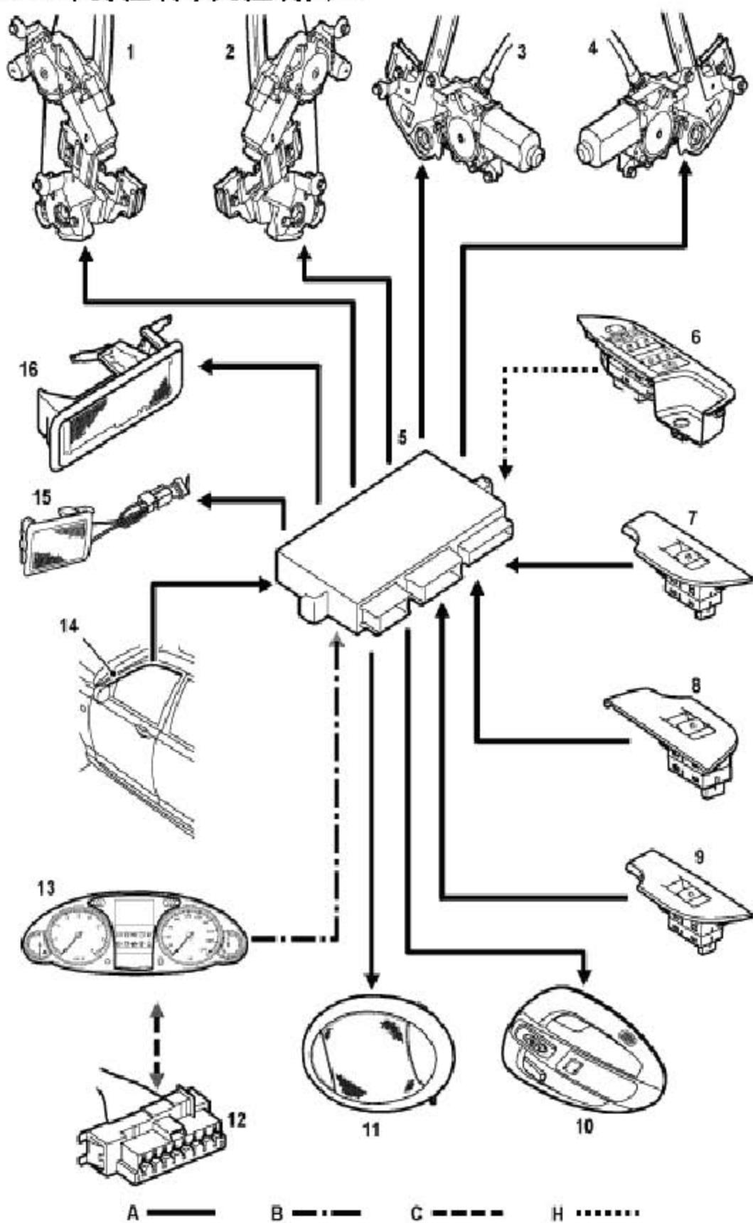
A= 硬线; B=K 总线; C= 诊断总线; H= 驾驶员侧门组合开关总线
