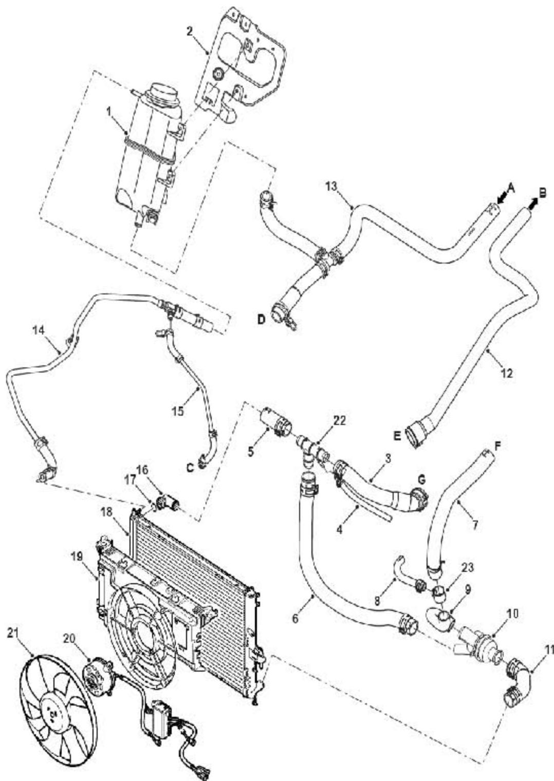
A= 暖风芯体进液口; B= 暖风芯体出液口; C= 气缸盖溢流孔;
