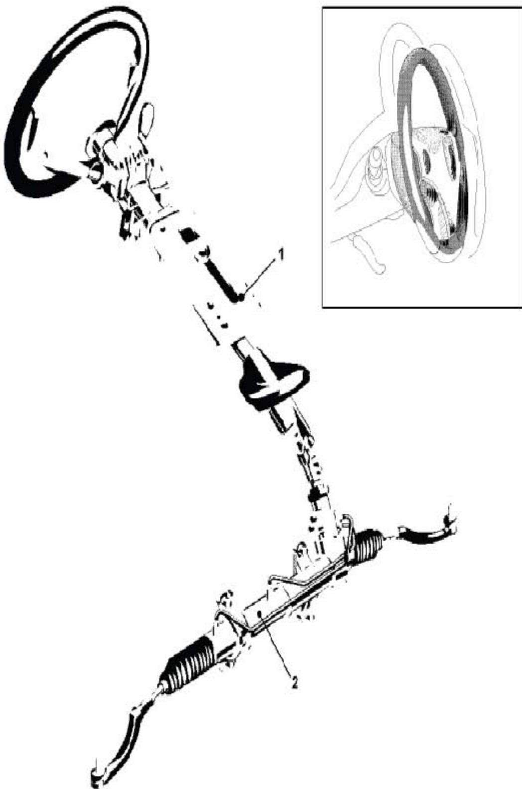
1 | 转向管柱总成
