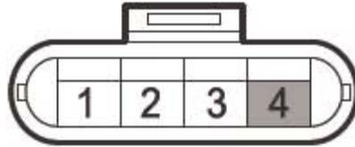
A). 用万用表检查燃油泵线束连接器S016 端子4 的与车身接地间的电阻值，确认接地线是否导通。电阻标准值：小于1  $\Omega$
