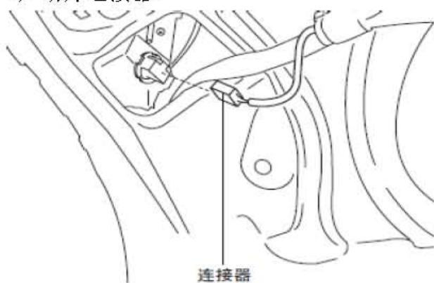
4). 沿图中所示的箭头方向转动插座，然后将其拆下。
