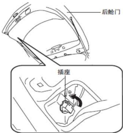
5). 拆下后雾灯灯泡（驾驶员侧）/倒车灯灯泡（乘客侧）。
