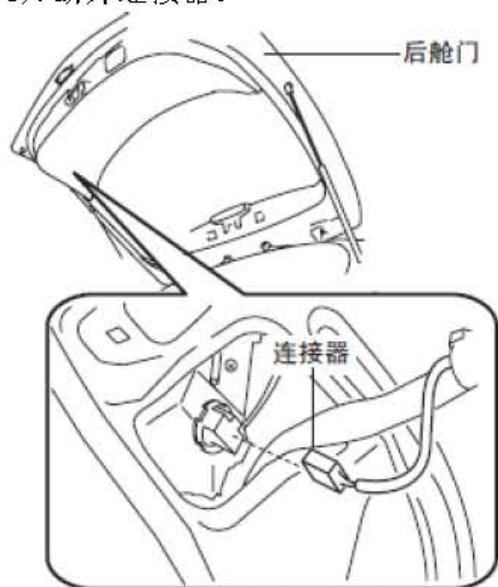
4). 沿图中所示的箭头方向转动插座，然后将其拆下。
