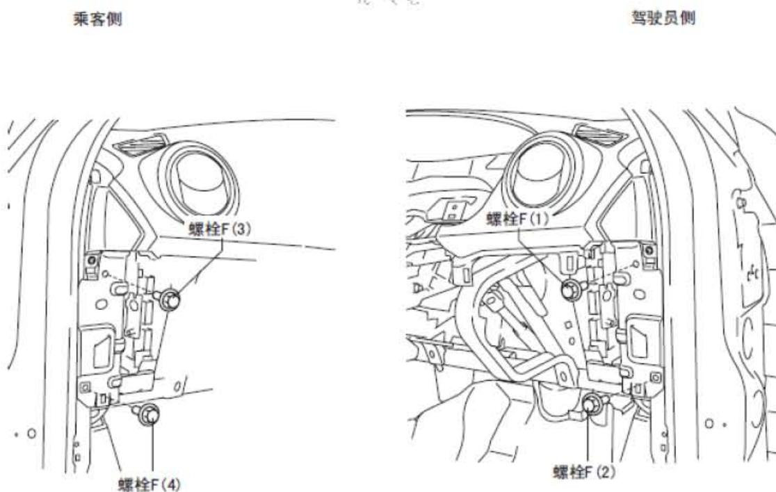
3). 重新确认安装仪表板的维修孔和内铰链柱，然后拧紧上侧螺栓F。
