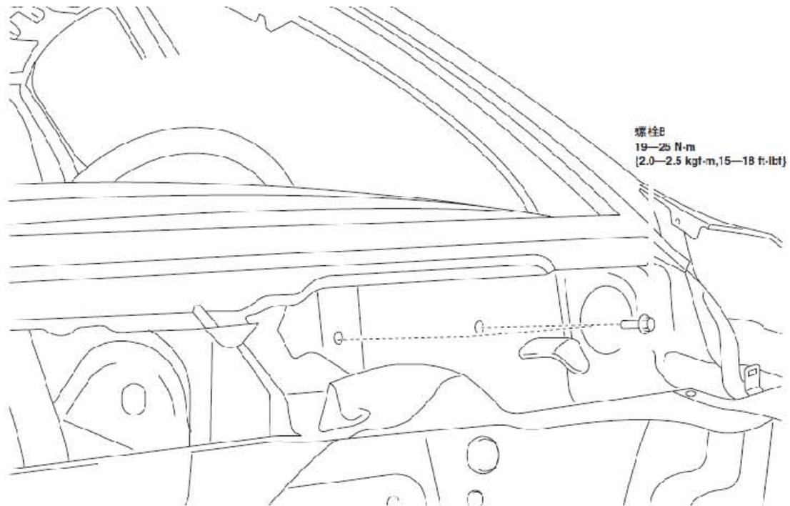
10). 拆下盖帽后，作一个纸筒，用来拆卸螺栓C。
