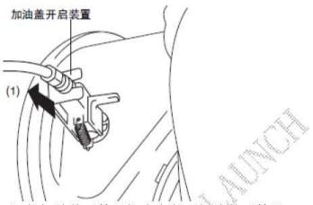
6). 从加油盖开箱器拉索上断开加油盖开箱器。
