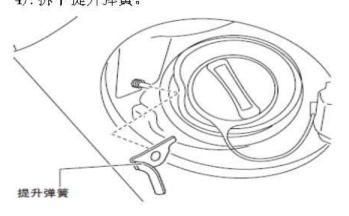
5). 沿箭头方向(1) 拉出燃油箱加油口开箱器。
