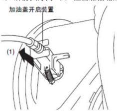
6). 从加油盖开箱器拉索上断开加油盖开箱器。
