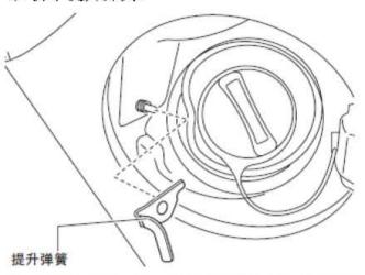
5). 沿箭头方向(1) 拉出燃油箱加油口开箱器。
