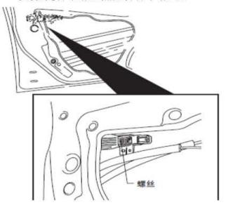
7). 沿箭头方向(1) 压下杆固定件, 并沿箭头方向(2)拆下前外手柄支架。
