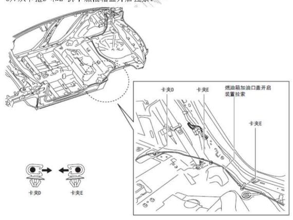
6). 从卡箍F 拆下燃油箱盖开启拉索。
