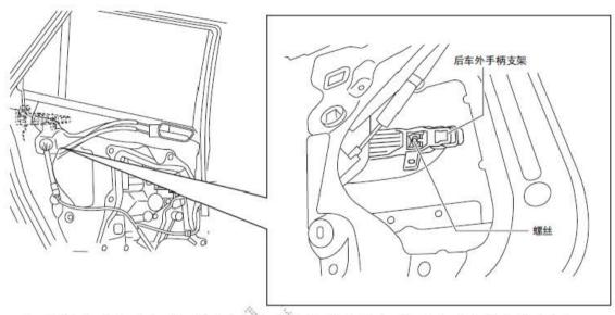
10). 沿箭头方向(1) 压下杆固定件, 并沿箭头方向(2) 拆下后外手柄支架。
