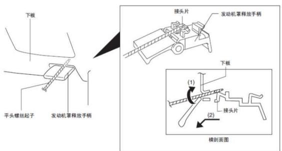
3). 向外拉锁开启拉手,从下面板上拆下锁开启拉手,然后分离发动机罩释放拉索。
