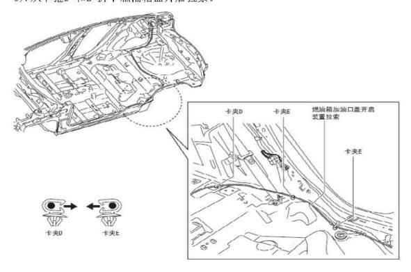
6). 从卡箍F 拆下燃油箱盖开启拉索。
