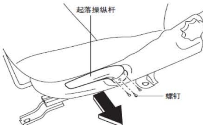
8). 用一块布，将斜躺式刻度盘安装夹拆下，从而将斜躺式刻度盘拆下。
