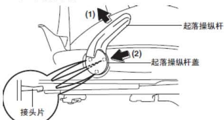
7). 拆下螺丝，然后沿箭头方向拆下起落操纵杆。
