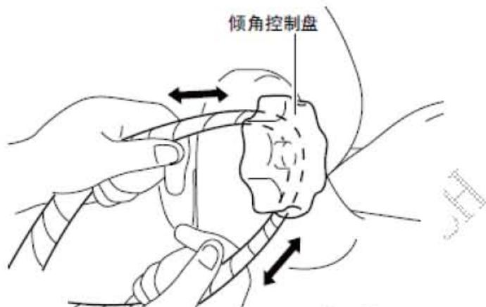
9). 按图示(3)、(4)、(5)的顺序拉动侧盖(从车门侧)以解开紧固件和锁片。
