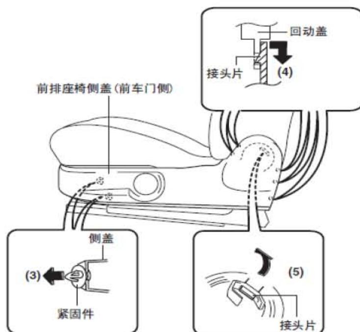
10). 拆下前排座椅边盖(前车门侧)。
