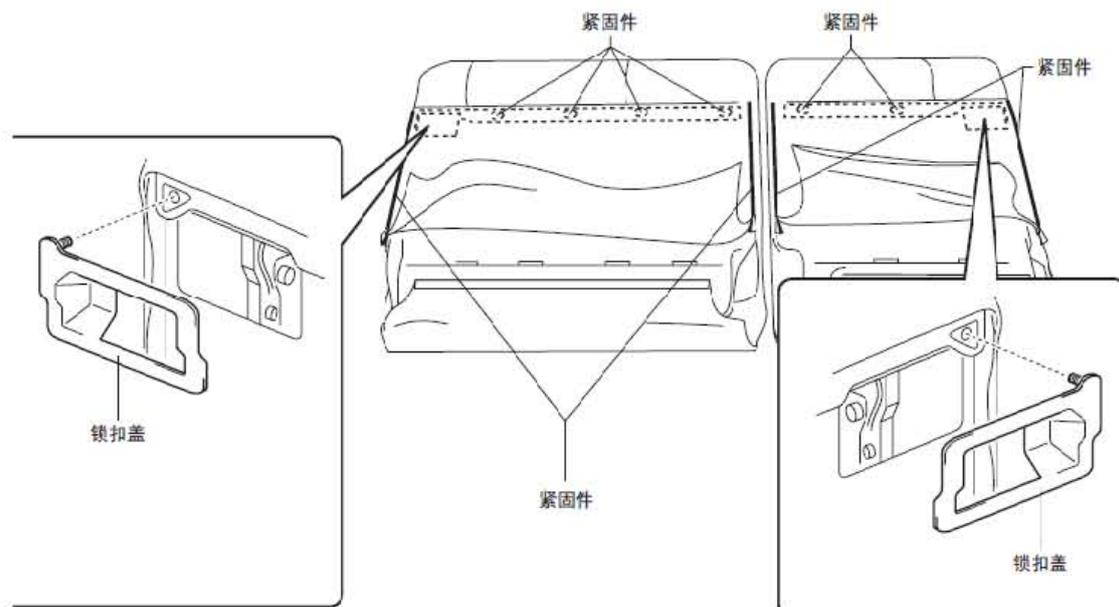
10). 拆下螺栓，然后拆下后排座椅中间扶手。（装配有后排座椅中间扶手的车辆）
