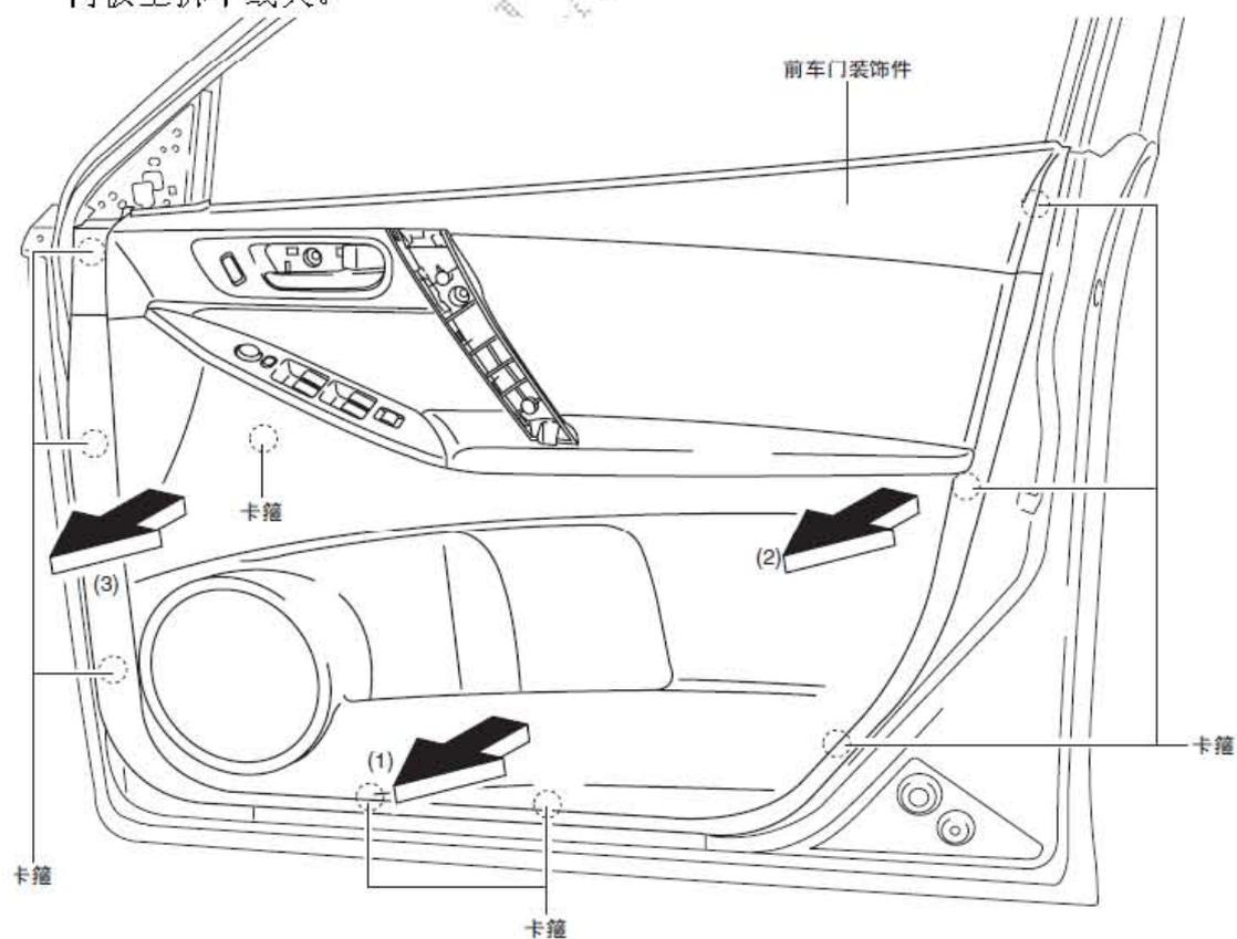
7). 沿图中所示的箭头方向拆下前门饰件。
