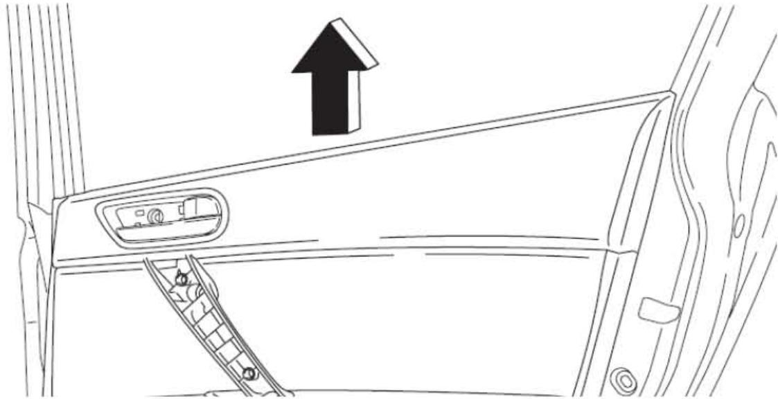
7). 拆下内手柄，并沿图中所示的箭头方向拆下后车门装饰板。
