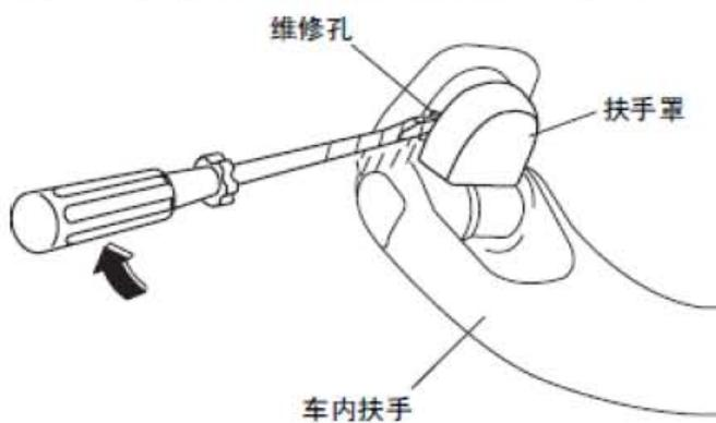
2). 沿箭头(1)和(2)的方向拆下扶手,同时分离夹子。
