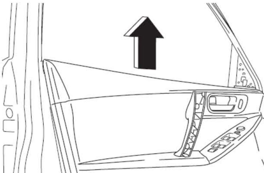
8). 拆下内手柄后，拆下图中所示的前门装饰板。
