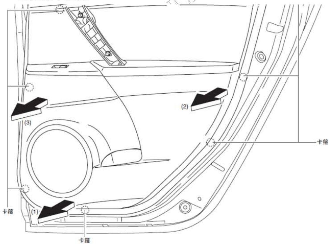
6). 沿图中所示的箭头方向拆下后车门装饰板。
