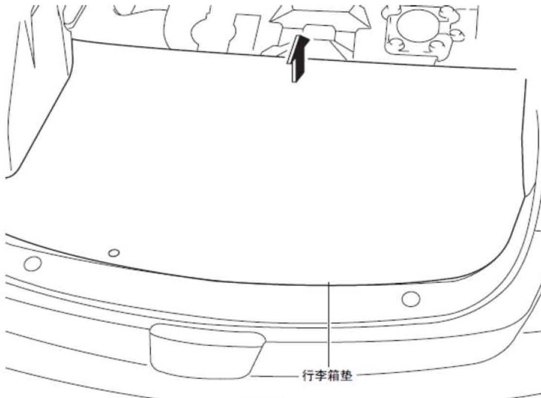
2). 按图中箭头所示方向拆下行李箱板。
