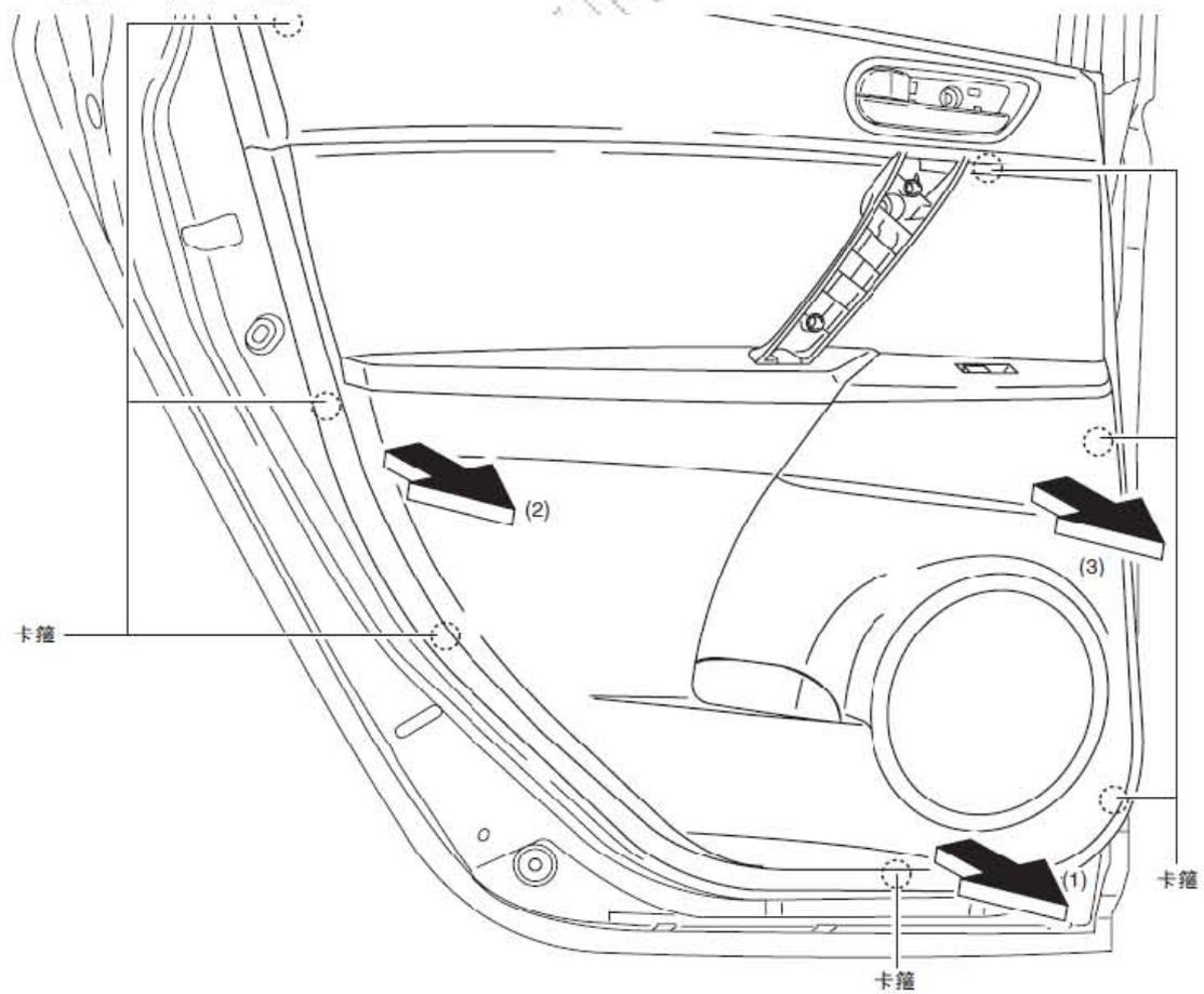
6). 沿图中所示的箭头方向拆下后车门装饰板。
