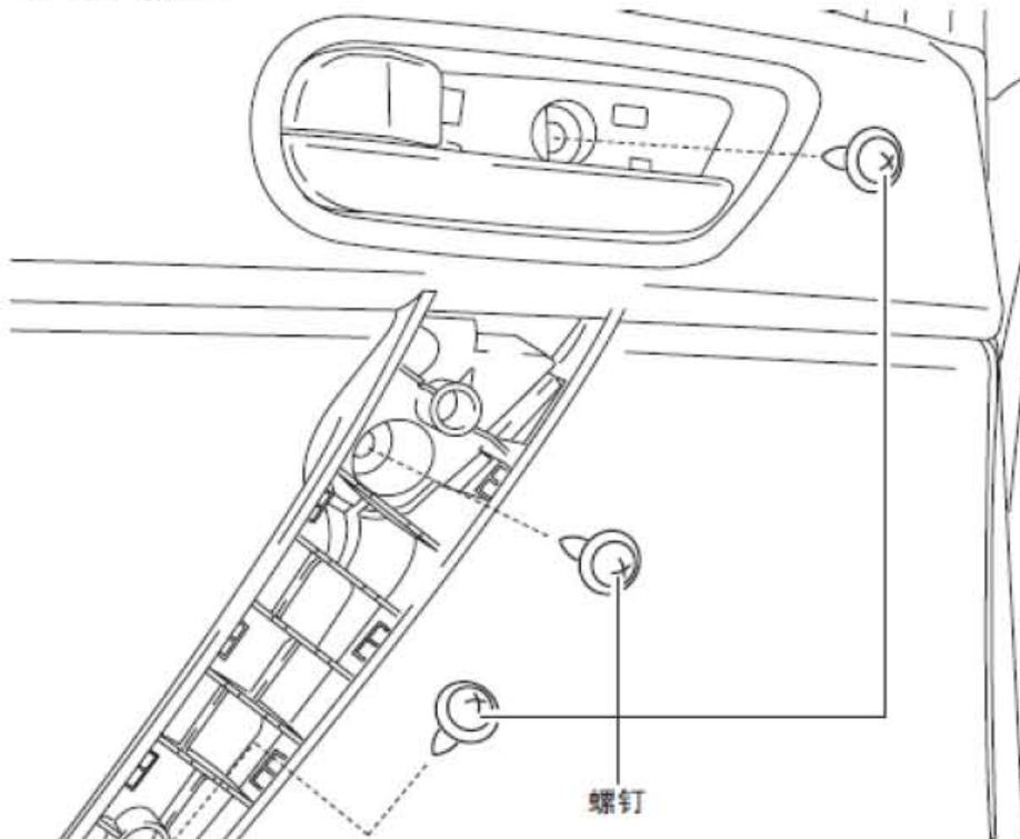
5). 沿图中所示的箭头(1)、(2)、(3)方向拉线夹，并用紧固件拆卸工具从车门内板上拆下线夹。
