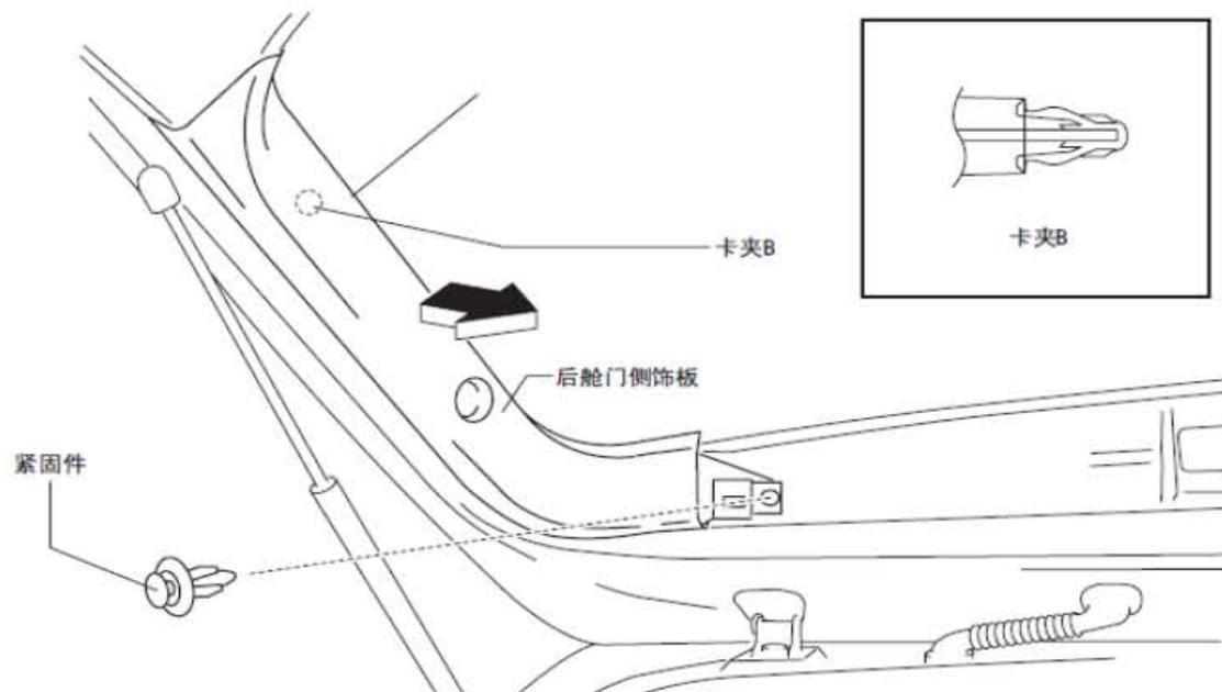
6). 按图示箭头(1) 的方向拉动后舱门侧壁装饰并分离锁定片C 和D, 然后按箭头(2) 的方向拉动并分离挂钩E。
