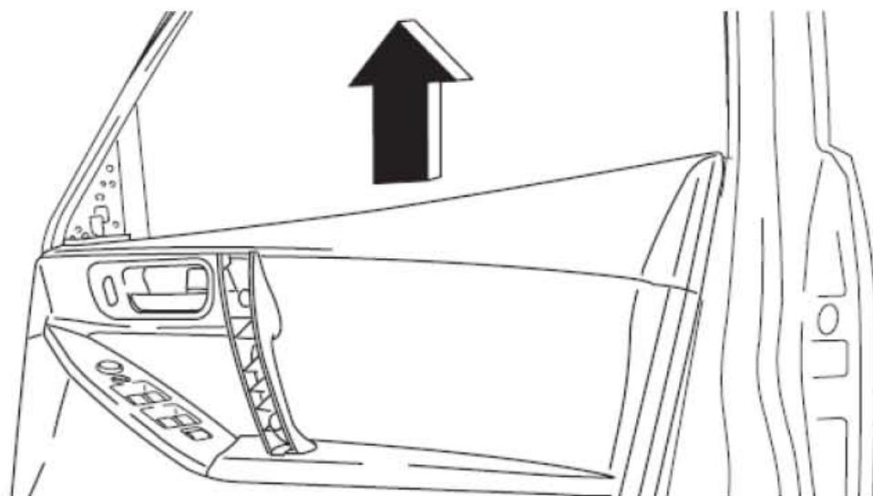
8). 拆下内手柄后，拆下图中所示的前门装饰板。
