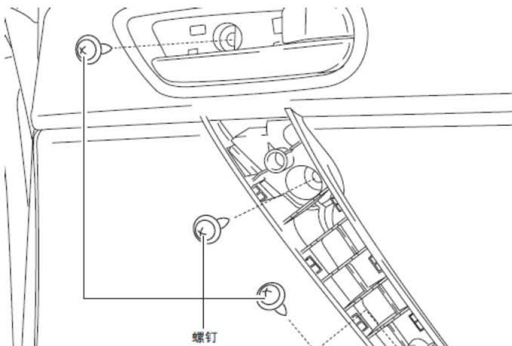
5). 沿图中所示的箭头(1)、(2)、(3)方向拉线夹，并用紧固件拆卸工具从车门内板上拆下线夹。
