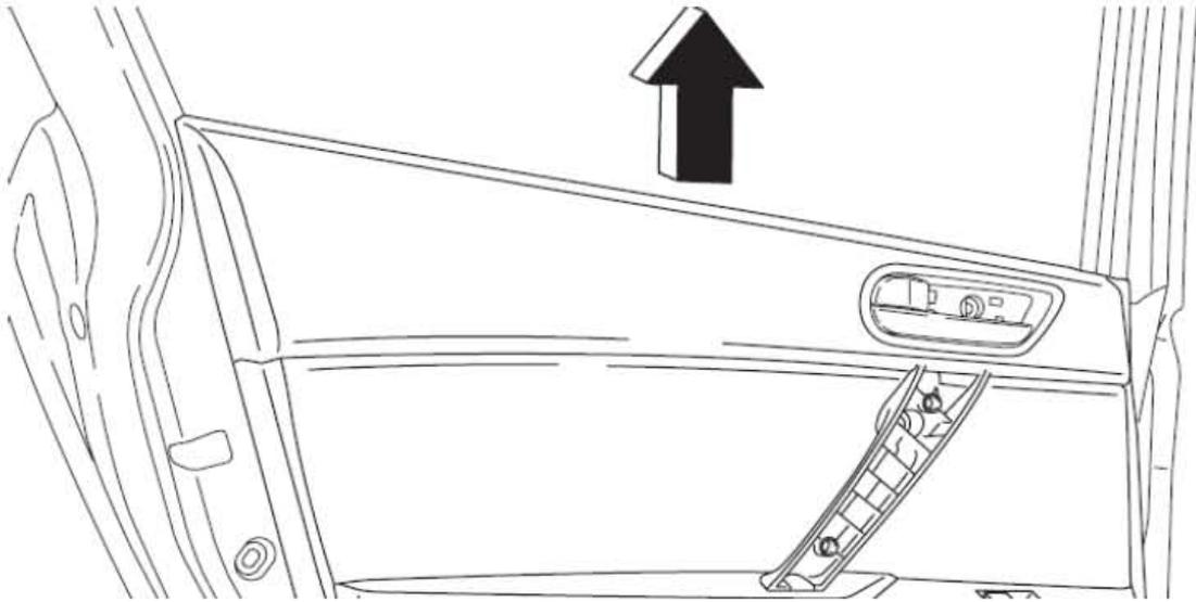
7). 拆下内手柄，并沿图中所示的箭头方向拆下后车门装饰板。
