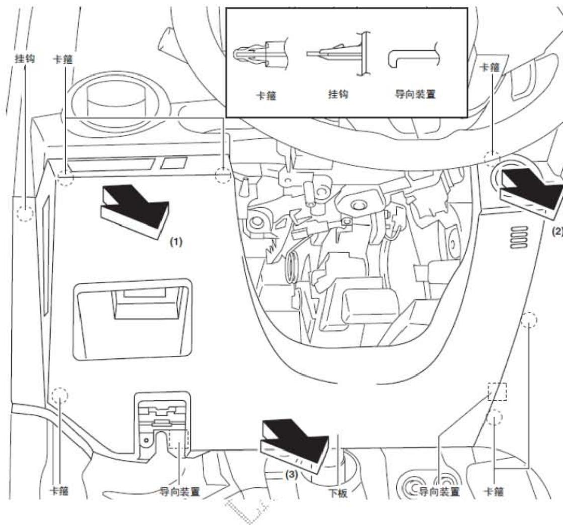
5). 沿箭头方向按(1)、(2)和(3)的顺序拉下面板，将挂钩、夹子和导杆分开并拆下下面板。
