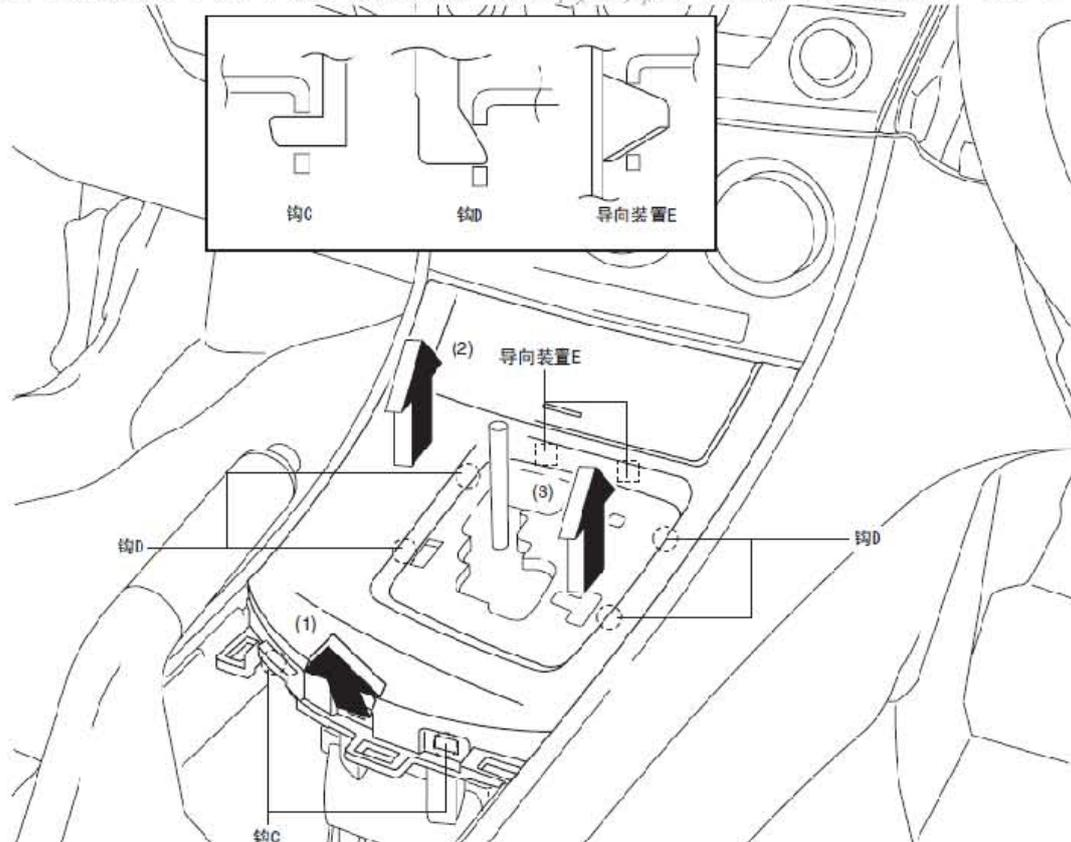
5). 拆下换挡面板。
