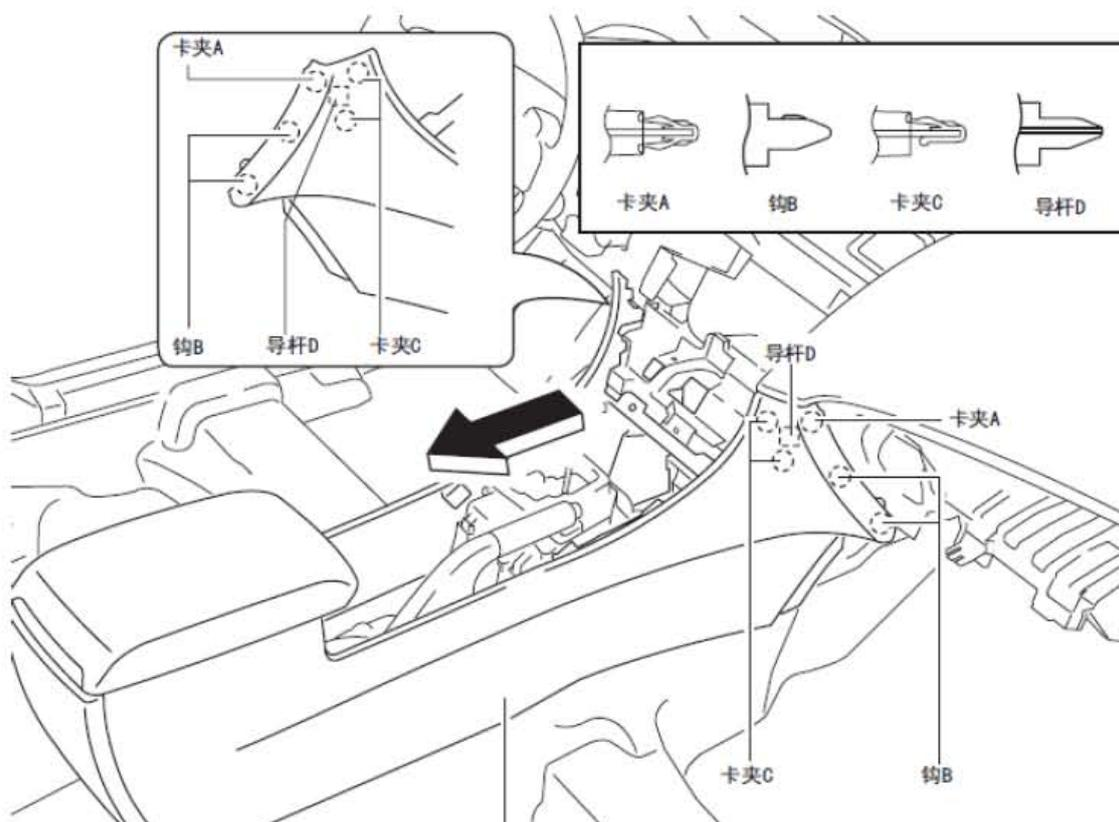
6). 沿图中所示的箭头 (1) 方向拉起控制台，沿箭头 (2) 方向移动后控制台，然后将其拆下，期间避免撞到驻车制动杆。
