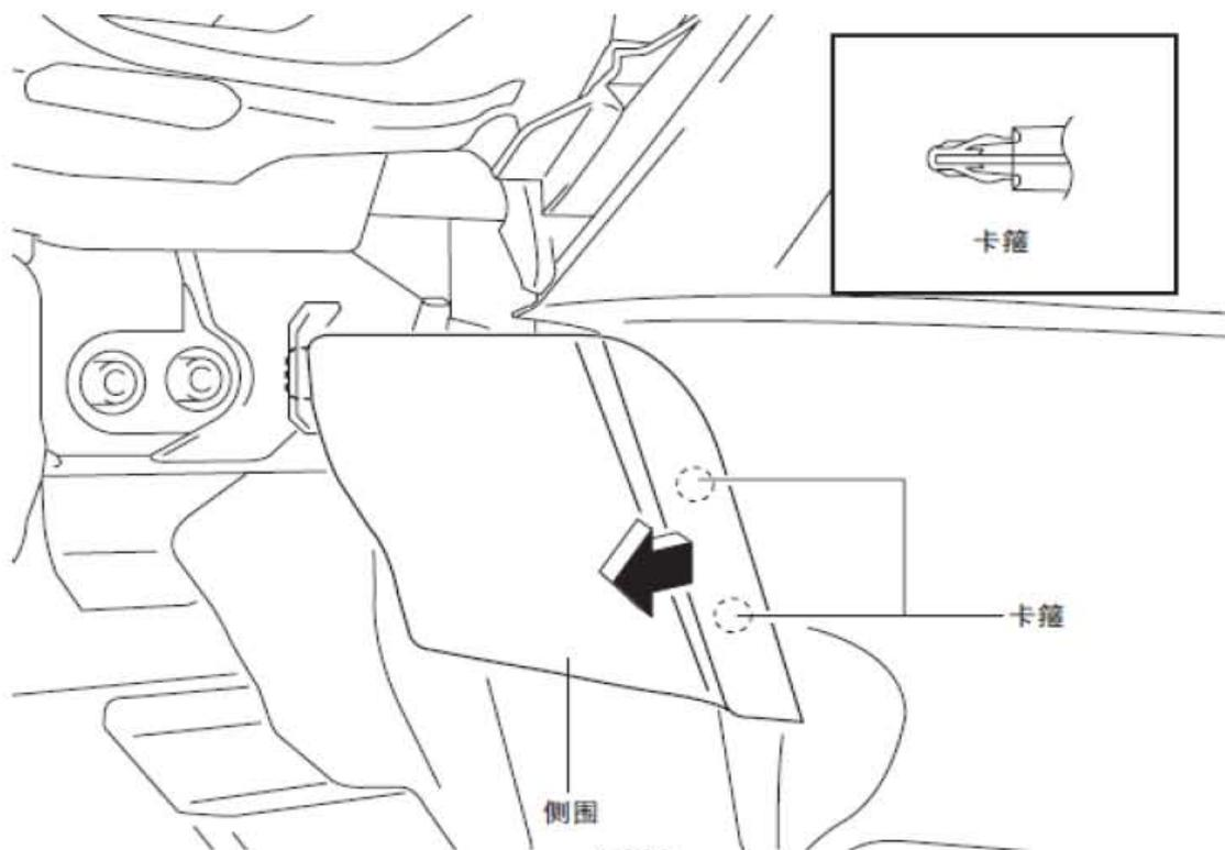
2). 按图中箭头所示方向拆下侧围
