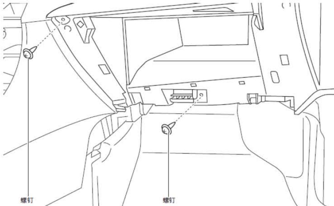
4. 沿箭头方向按(1)、(2)和(3)的顺序拉下面板, 将挂钩、夹子和、导杆和销分开并拆下下面板。
