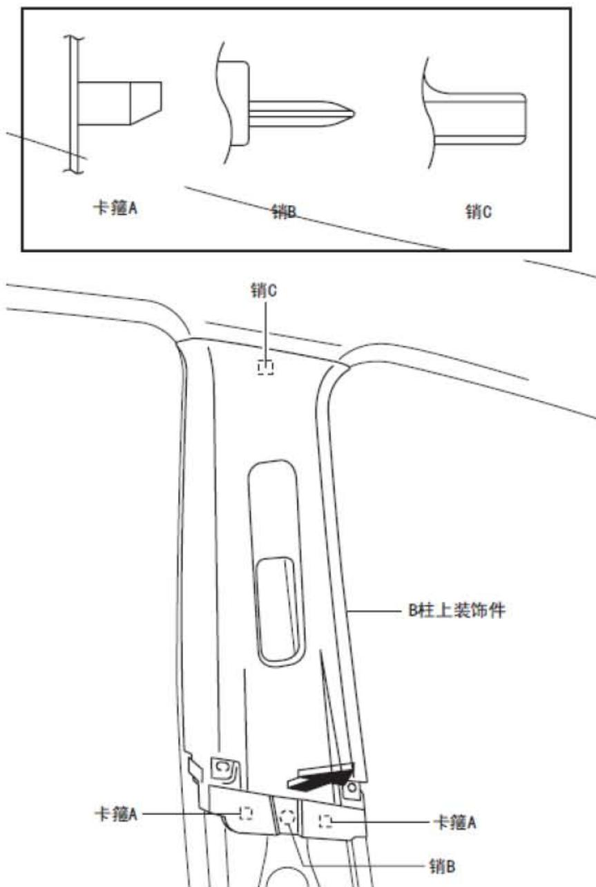
5). 沿图中所示的箭头方向拆下B 柱上部饰件。
