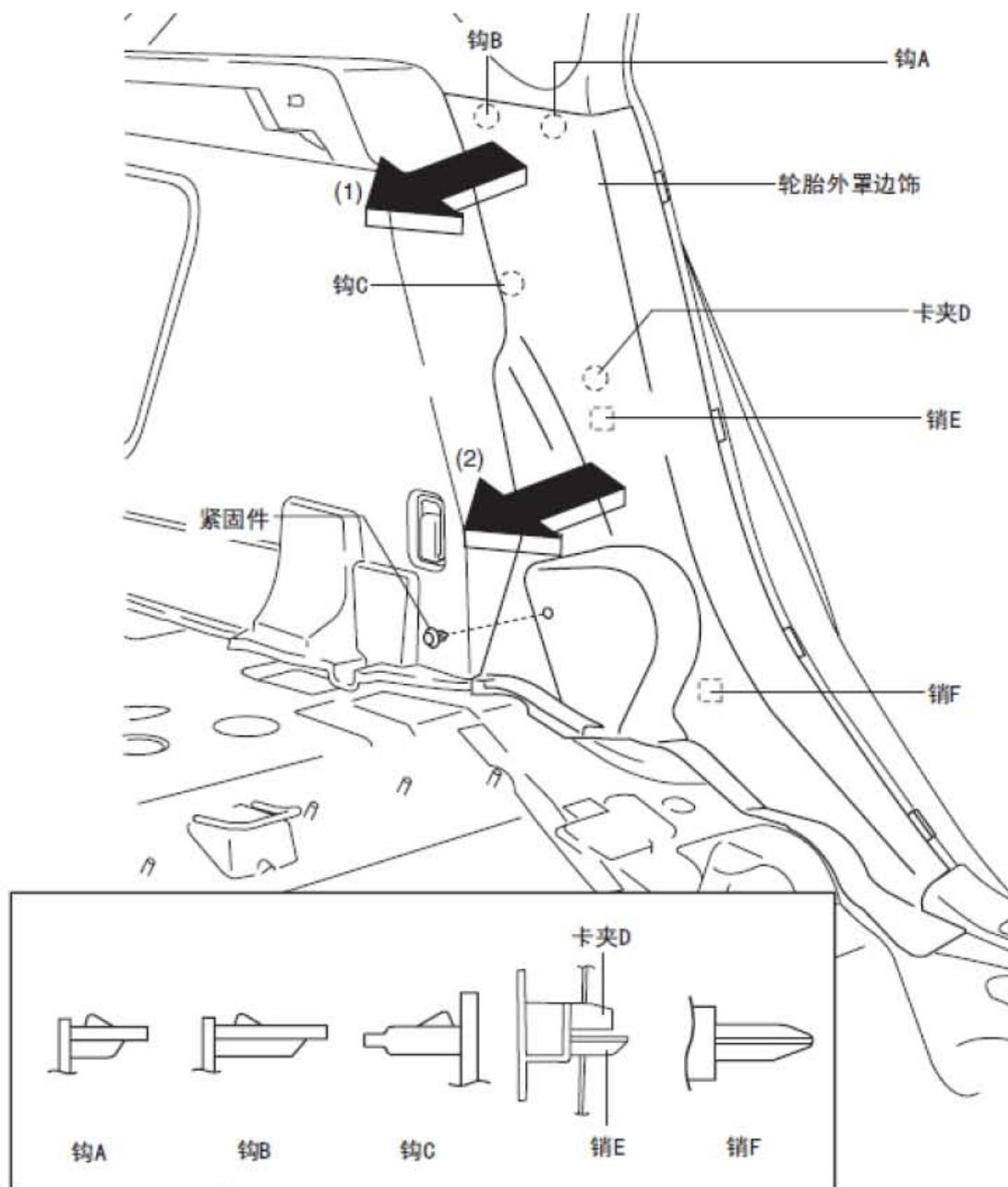
6). 按箭头(2) 所示的方向拉轮胎外罩边饰，同时拆下挂钩C、夹子D、销E 和F。
