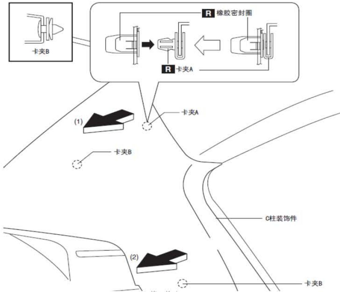
4). 用钳子剪掉与夹子A 和孔圈连接的导线，沿图中所示的箭头方向拉出C 柱装饰条，同时拆下凸耳C。
