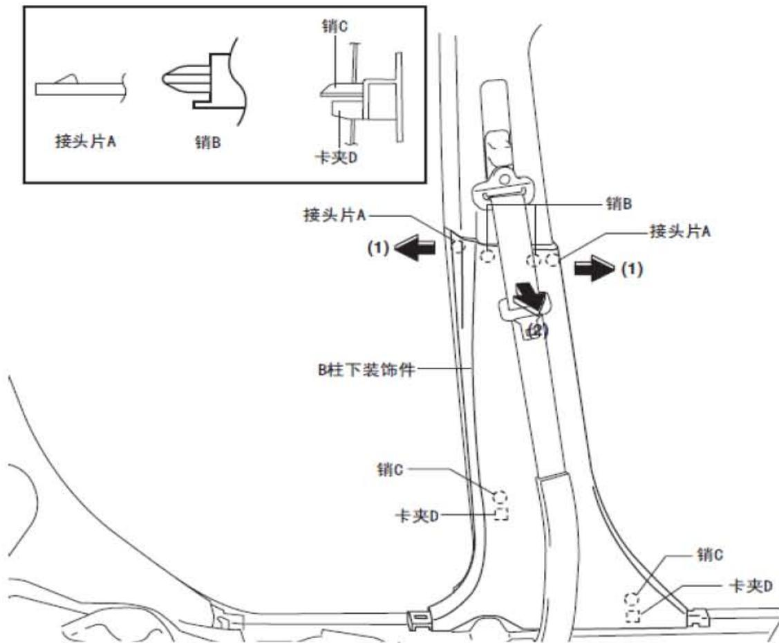
5). 沿图中所示的箭头 (3) 方向拆下B 柱下部饰件。
