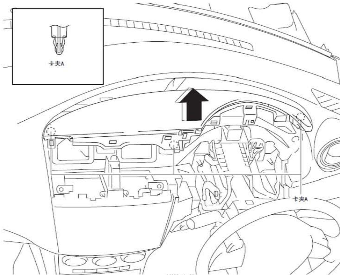
5). 按图中所示的箭头方向拉起仪表板上面板，然后拆下夹子。
