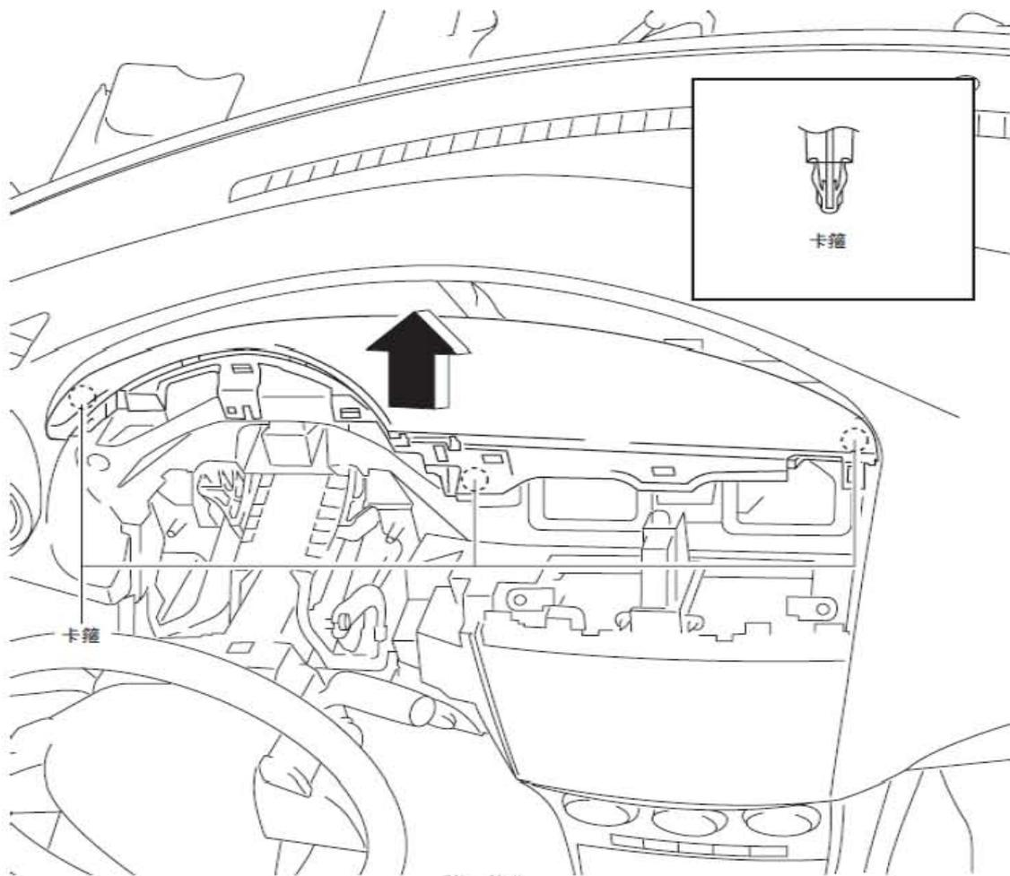
5). 按图中所示的箭头方向拉起仪表板上面板，然后拆下夹子。
