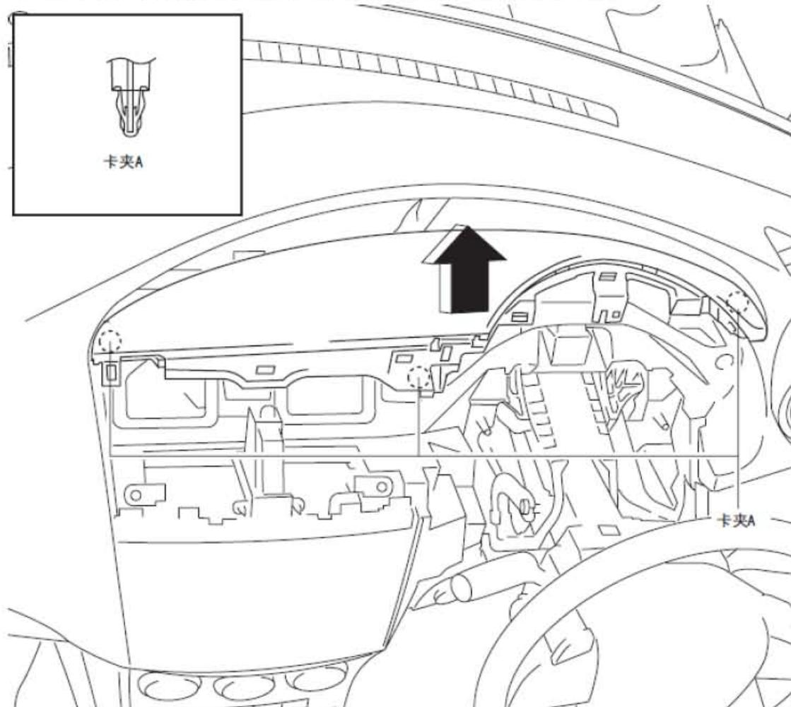
5). 按图中所示的箭头方向拉起仪表板上面板，然后拆下夹子。
