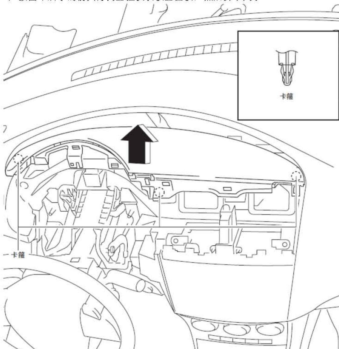
5). 按图中所示的箭头方向拉起仪表板上面板，然后拆下夹子。
