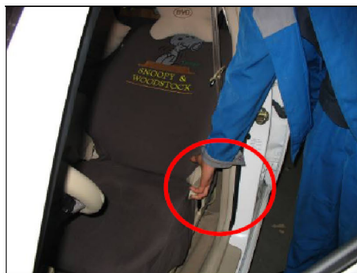
图二：拉动靠背调节手柄座椅靠背不回位
