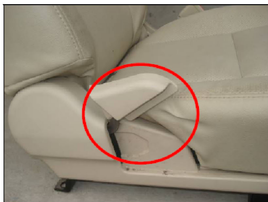
图一：靠背调节手柄卡滞座椅靠背不回位
